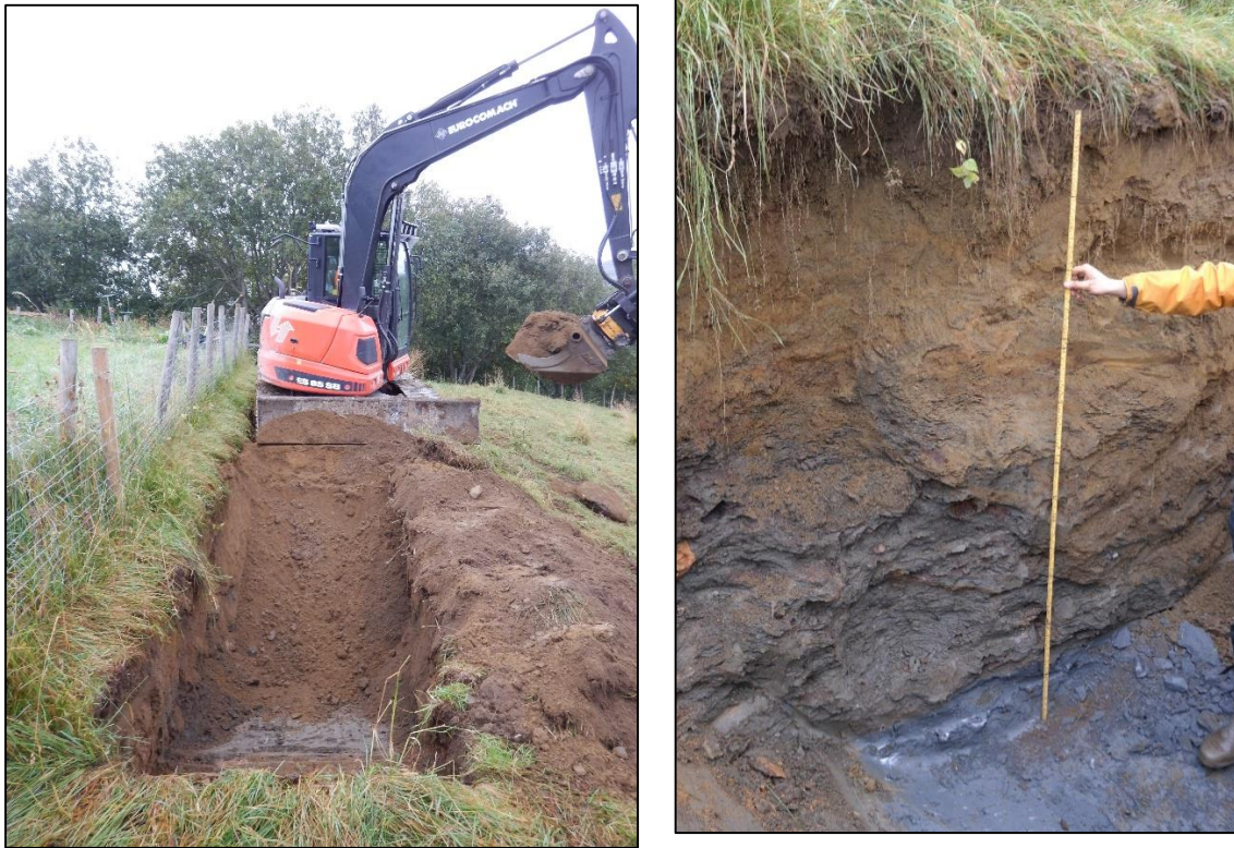
Figur 4.2: Bilde frå storskala snitt på Ljøsegga, lokalitet 287. Gravemaskin vart nytta for å få snittet stort og djupt nok. Meterstokken som skala er 2 m (Foto: Det venstre biletet er teke av Jørgen Langeland, og bilete til høgre er teke av Hilde Dalen Jordet, 18.09.2015).
