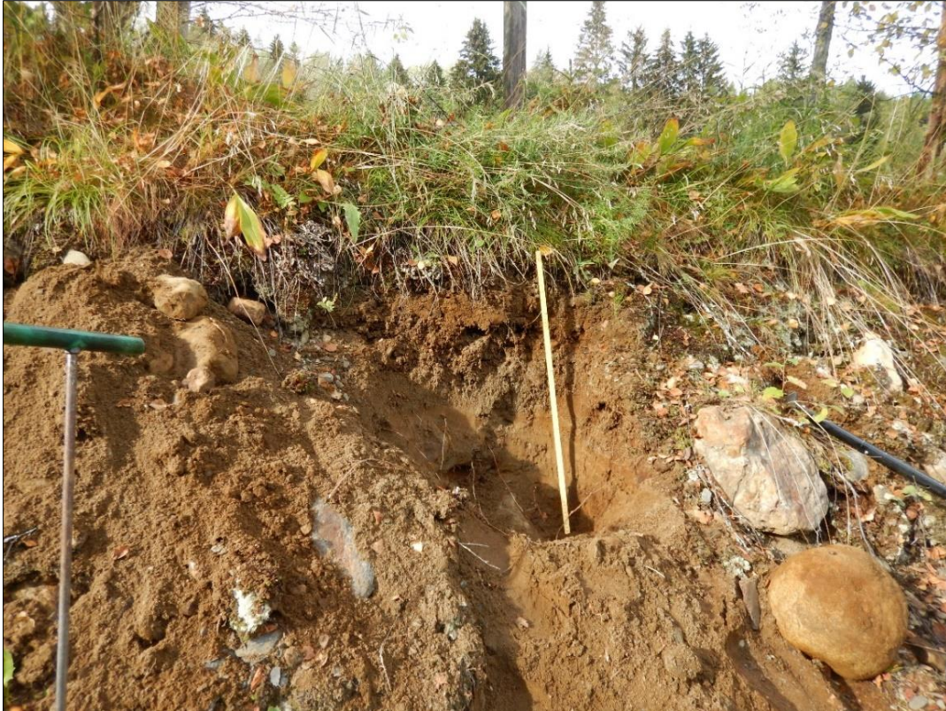
Figur 5.4: Snitt i Material 3, lokalitet 292. Grovt og godt runda materiale i overflata og meir finkorna og sortert djupare. Meterstokk som skala, snittet er 0,7 m djupt (Foto: Jørgen Langeland, 24.09.2015).
