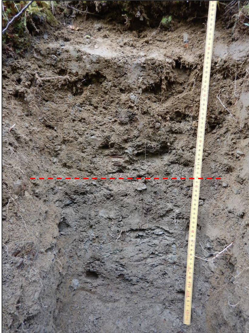
Figur 5.2: Snitt av Material 1, der overgangen mellom laga er markert med stipla raud linje. Bilete er frå lokalitet 333, og snittet er om lag 60 cm høgt (Foto: Jørgen Langeland, 08.10.2015).
