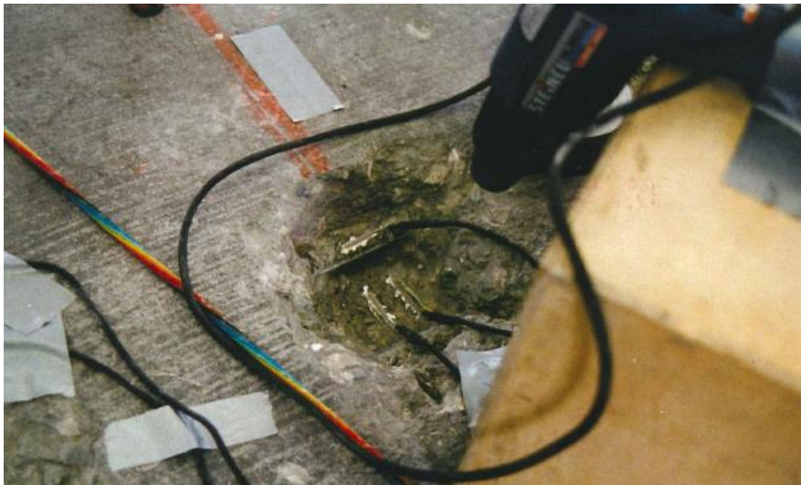
Figur 42: Strekkklapper festet til lengde- og tverrarmeringen i brudekket.
