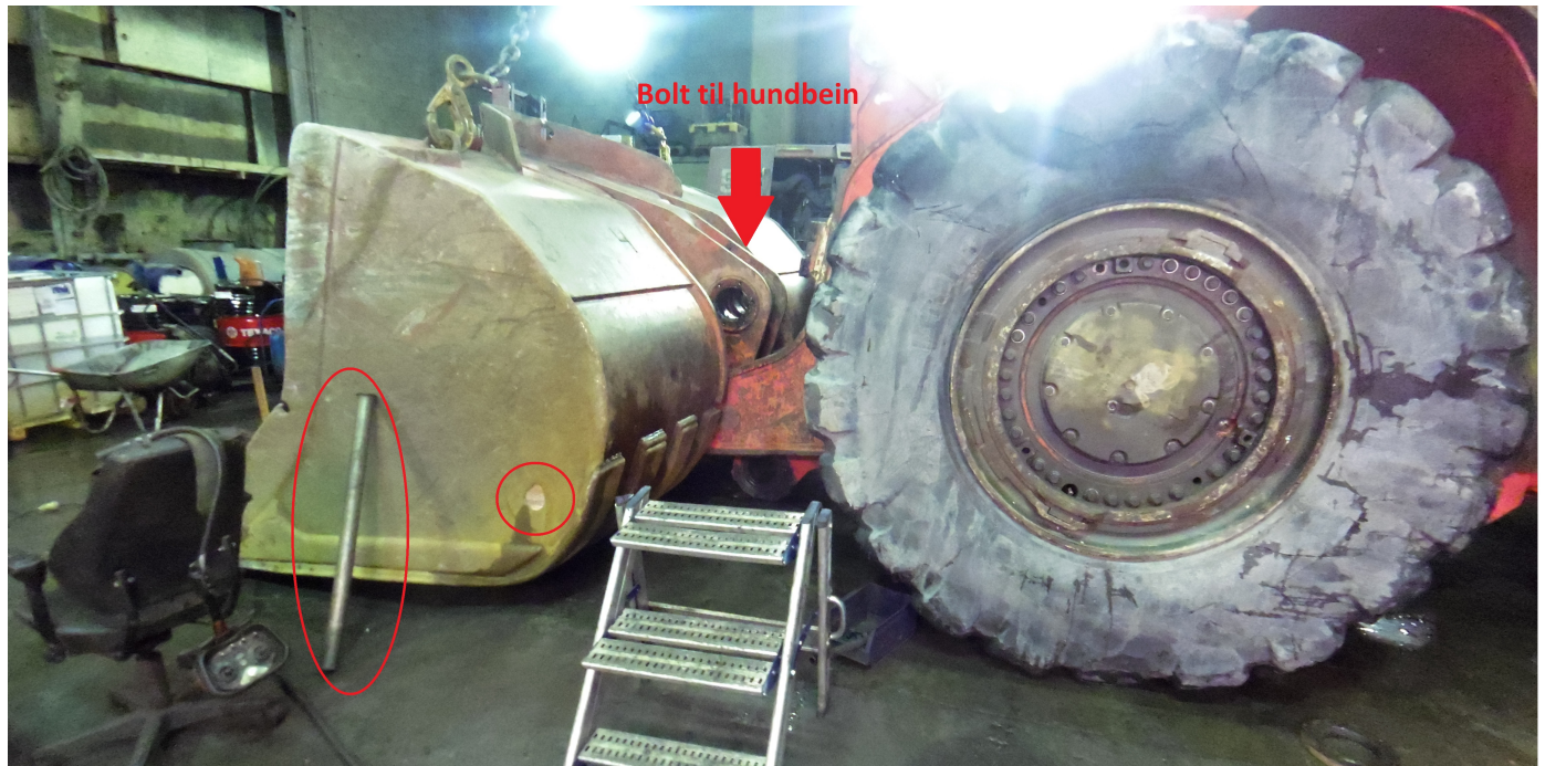
Figur 4.6: Fjerning av bolt til hundbein og løftearm
