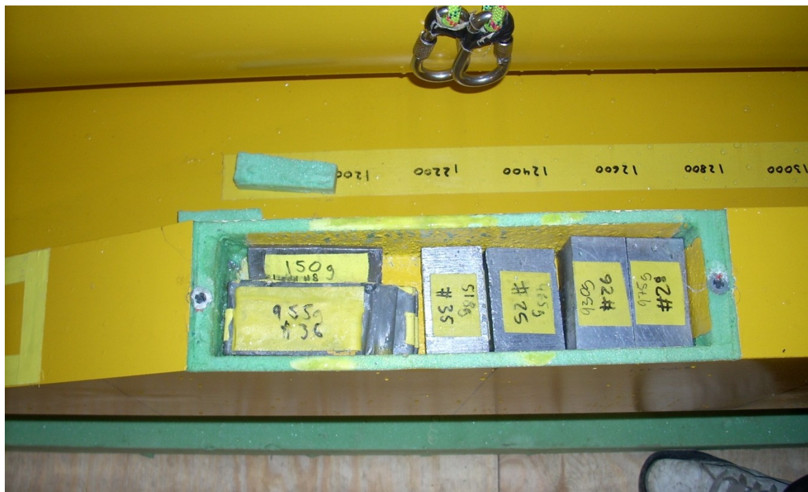
Figur V-81 – Oppsett av lodd under sea-keeping forsøk i styrbord ballasttank
