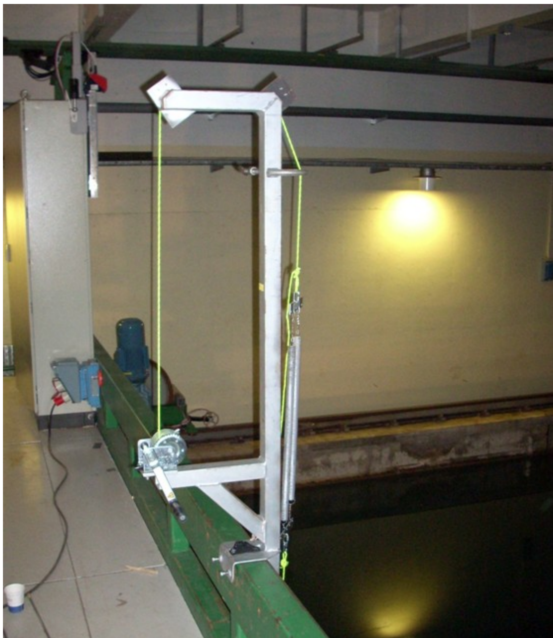
Figur X-83 – Skisse av fjærssystem benyttet under sea-keeping test
