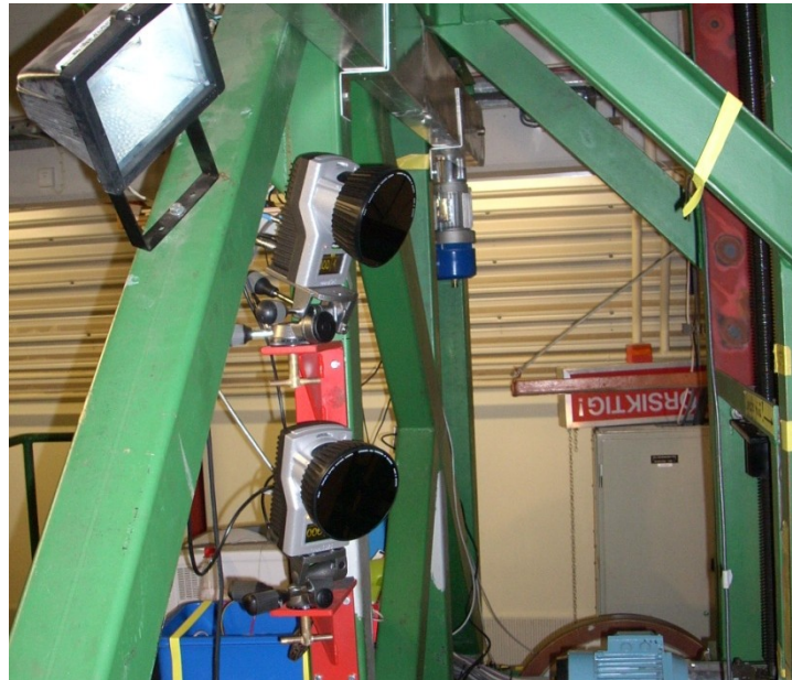
Figur 13 – Kameraer for optisk målesystem på den ene siden av slepevogna
