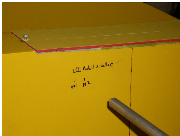
Figur 28 – Målepunkt for langskips tyngdepunkt før og etter modellforsøk
