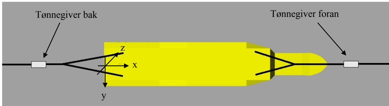
Figur 16 – Oppsett av tønnegivere (Modifisert tegning fra Torbjørn Mannsåker)
