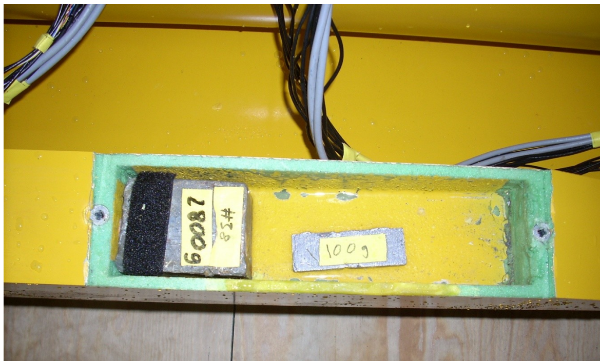
Figur V-82 – Oppsett av lodd under sea-keeping forsøk i babord ballasttank
