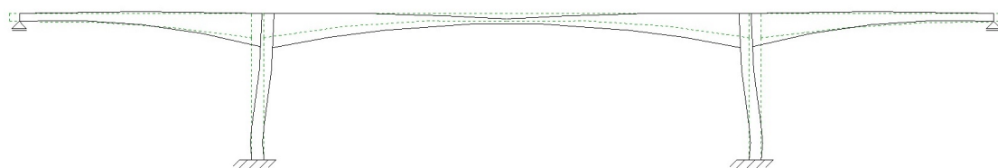
Figur 2.3: Typisk deformasjonsform for FFB etter lang tid
