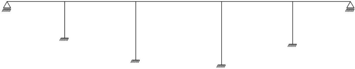
Figur 4.2 Statisk system for Sagbakken bru
