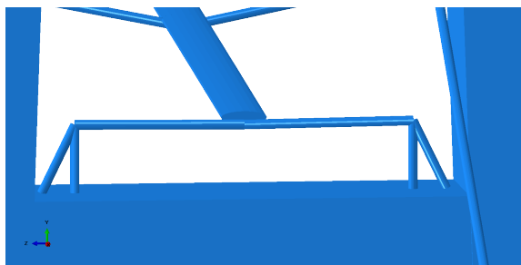
Figur 33: Her er modellen for A-rammene som forbinder brubanen til tårnene.
