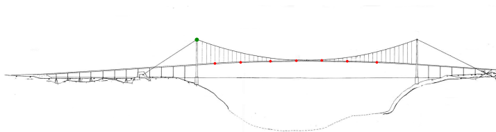
Figur 2: Oversikt over hvor nodene er plassert på brua, rødt er akselerometer, grønt er hovedloggekasse.
