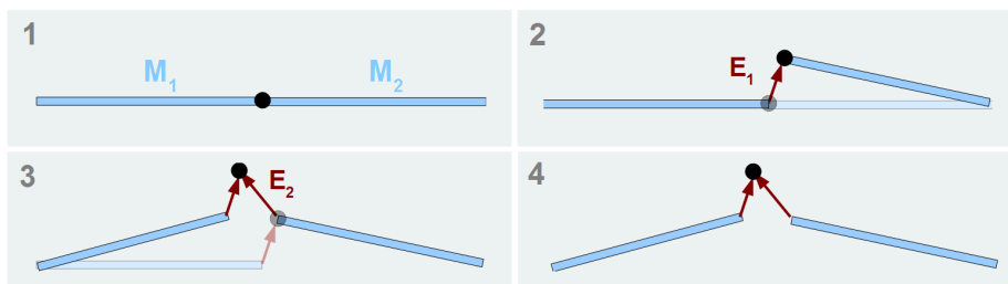
Figur 3.49: Et joint med to eksentrisiteter av typen MoveJoint .
