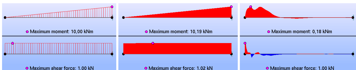
Figur 3.56: Moment- og skjærkraftdiagram for fast innspent bjelke med hhv. 50, 5000 og 100000 elementer.
