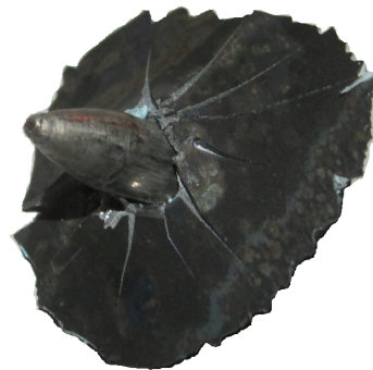
(d) Test no. 7: Back plate halo.
