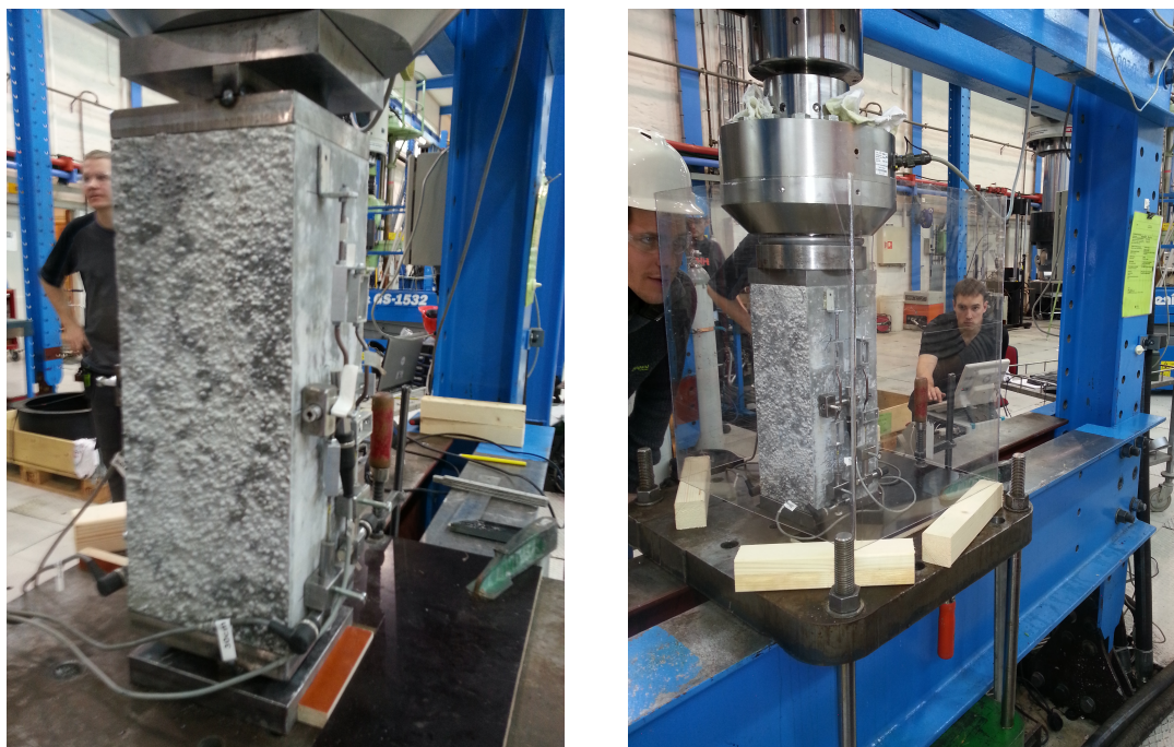
Figur 3.9: Oppsett av eksentrisk(venstre) og sentrisk(høyre) belastning
