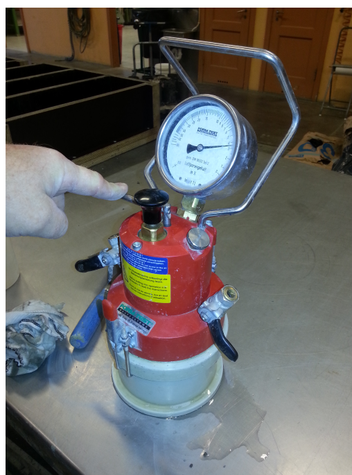
Figur 3.3: Måling av synkutbredelse, luftinnhold og densitet av fersk betong
