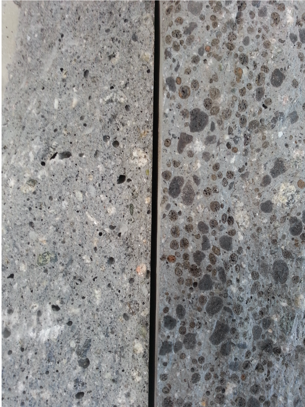
Figur 4.3: Bruddflate for prøvestykker NDC t.v. og LWC t.h.
