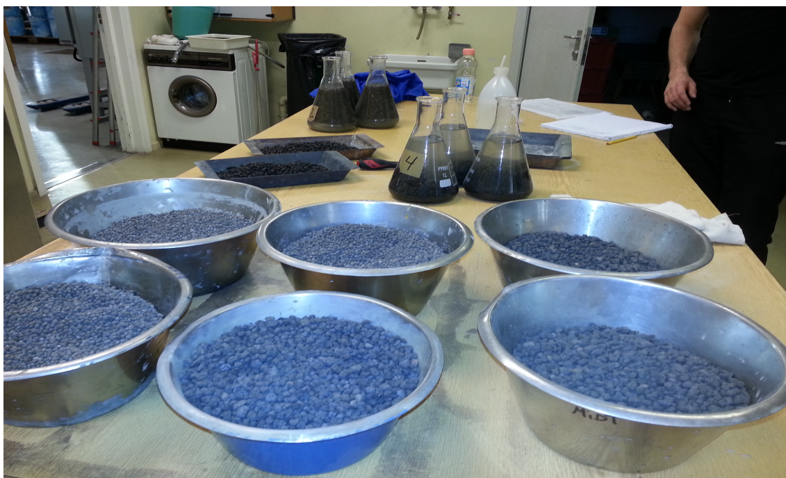
Figur 3.2: Måling av fuktabsorpsjon og fuktinnhold av tilslagene
