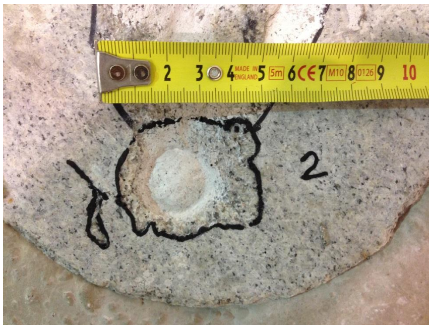
Figur 5.8: Krater fra prøve nummer 2; kuleformet spiss mot granitt
