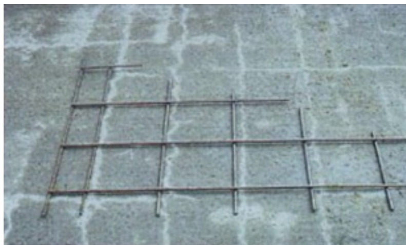
Figur 8.3: Typisk plastisk setningsriss [26]
