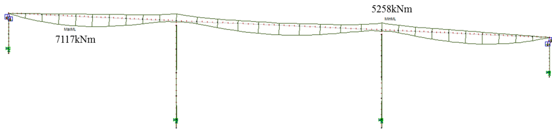
Figur 6.5: Momentdiagram for trafikklast
