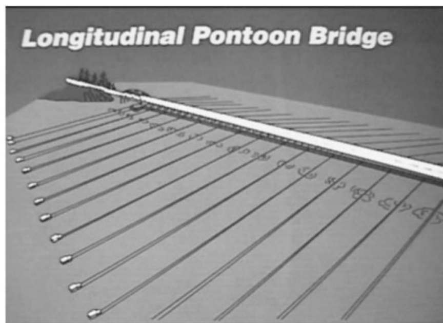
Figur 2-2 Kontinuerlig flytebru med sideforankring, hentet fra (Chen & Duan, 2000)
