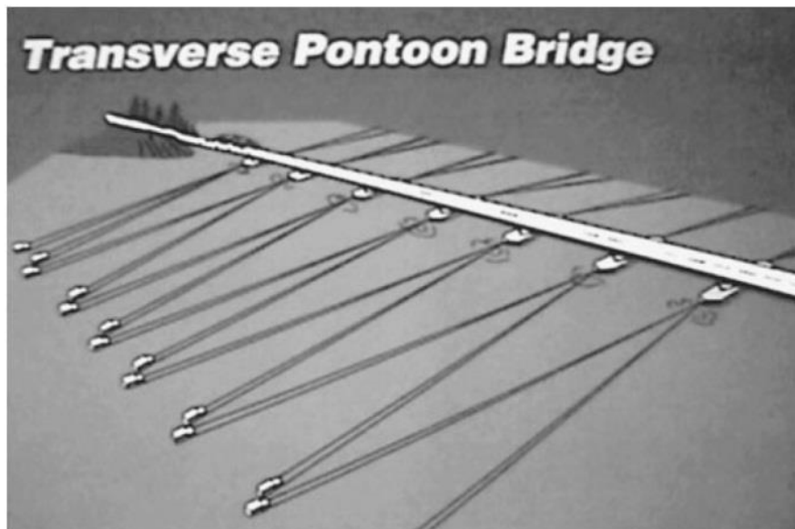
Figur 2-3 Separat pongtongbru med sideforankring, hentet fra (Chen & Duan, 2000)
