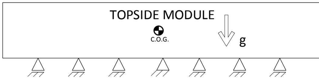
FIGURE 41: RIGID SUPPORTS OF MODULE
