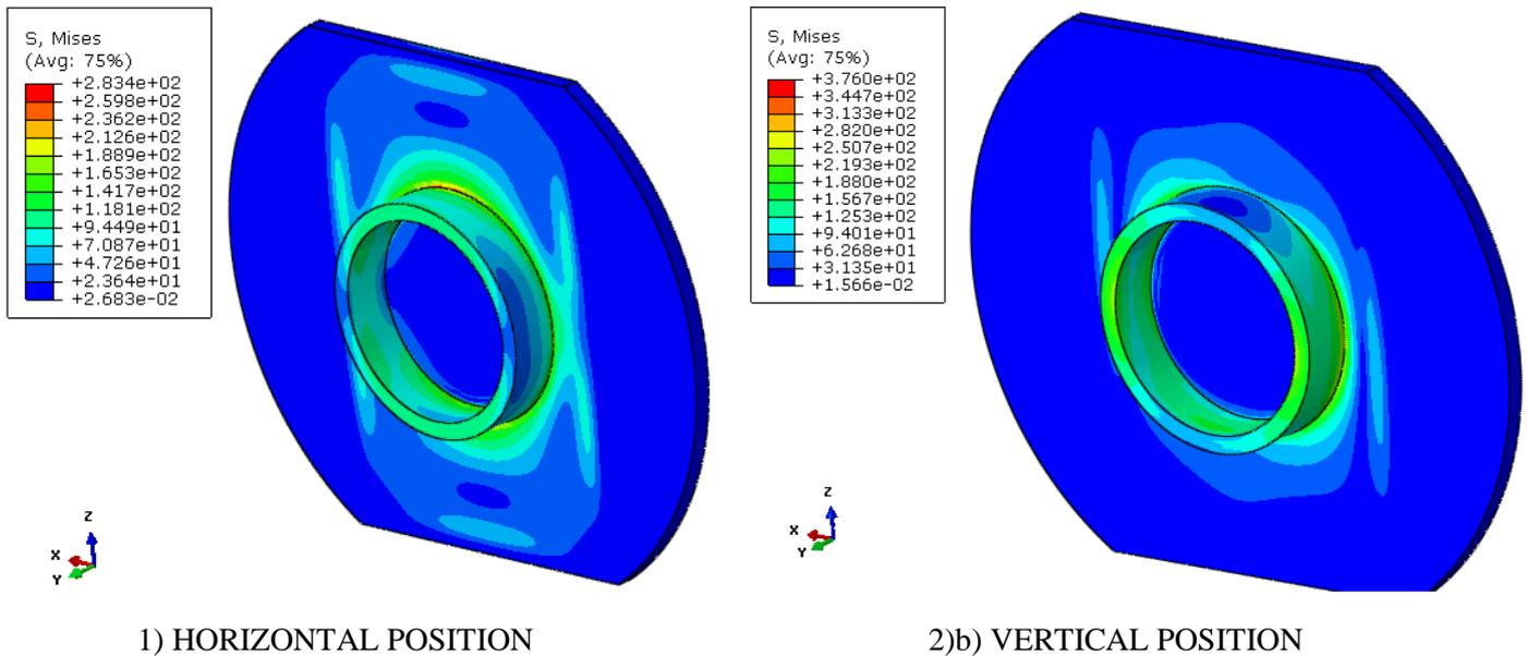
FIGURE 94: STRESS DISTRIBUTION IN REAR TRUNNION
