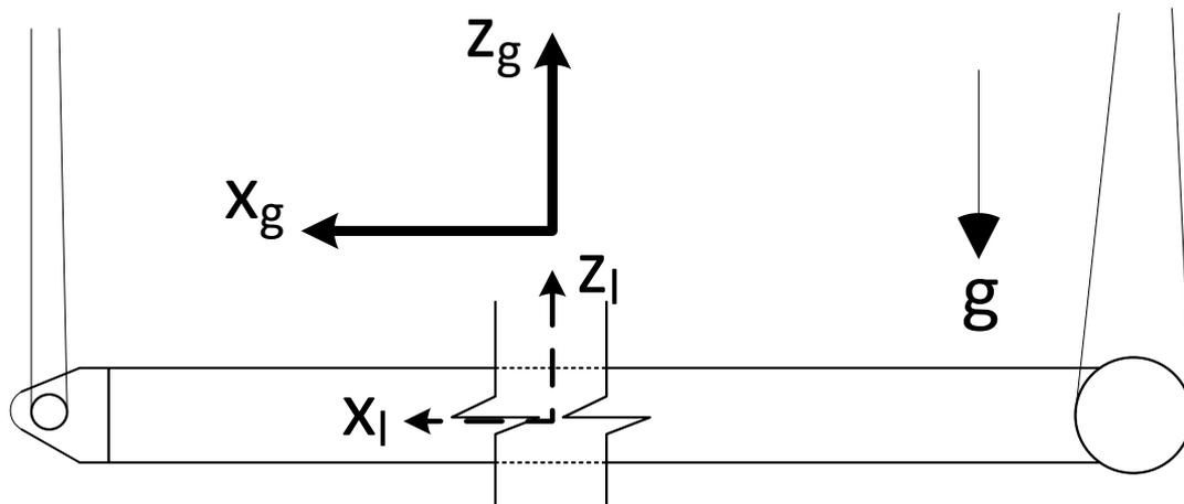
FIGURE 33: LOCAL AND GLOBAL COORDINATE SYSTEMS. FRAME IS IN HORIZONTAL POSITION
