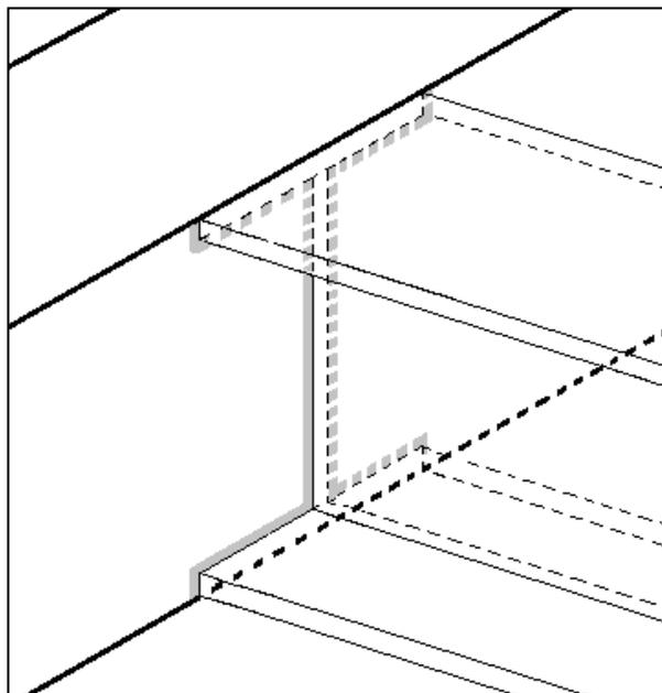
FIGURE 100: LONGITUDINAL - REAR BEAM JOINT
