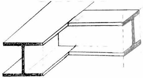
FIGURE 17: JOINT OF I/H BEAMS
