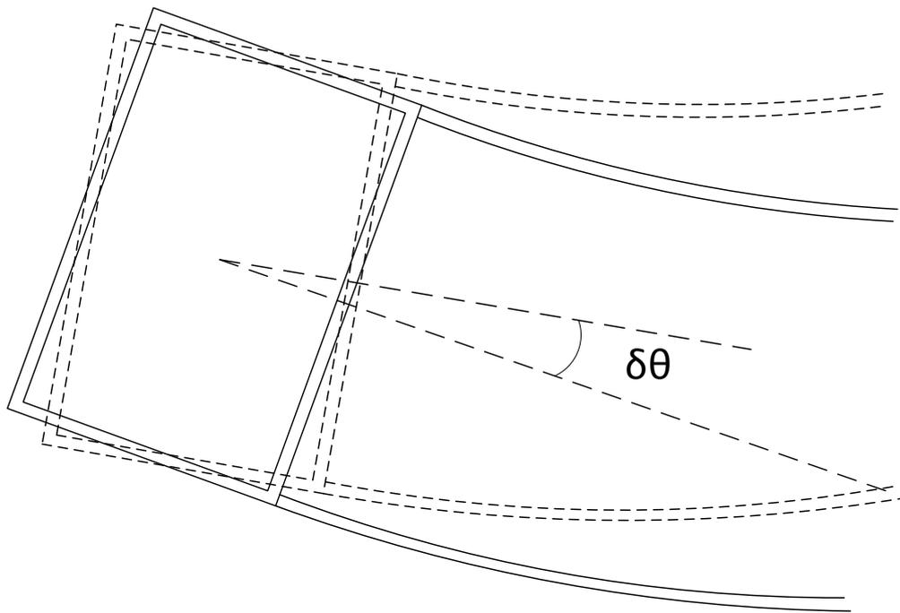
**FIGURE 60: DIFFERENCE IN ROTATION IN JOINTS BETWEEN LONGITUDINALS AND FRONT/REAR BEAMS**
