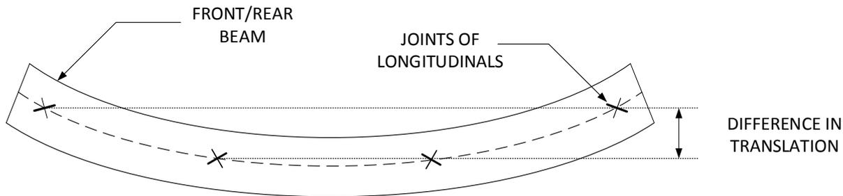
**FIGURE 58: TRANSLATION OF SUPPORTS OF LONGITUDINAL BEAMS DUE TO BENDING OF FRONT AND REAR BEAMS**
