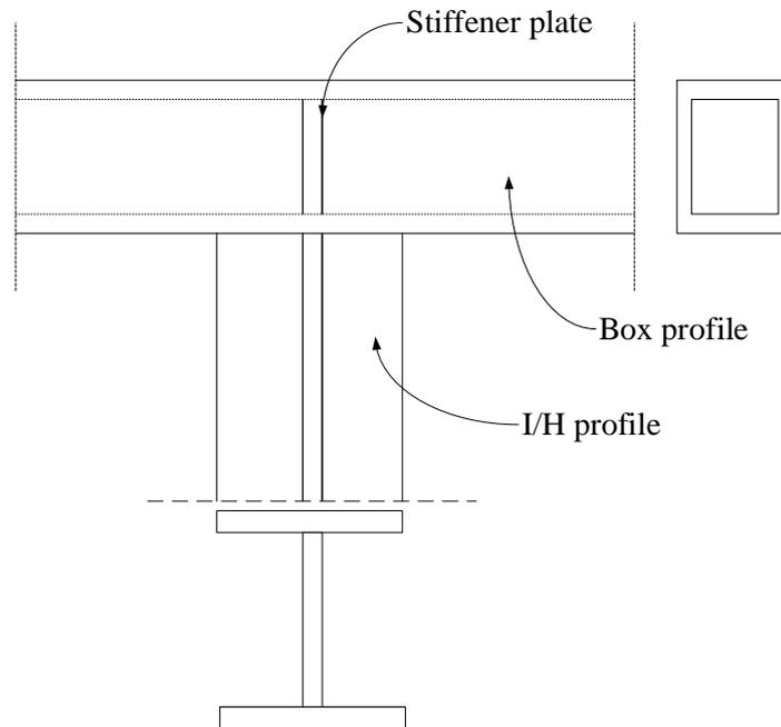
FIGURE 19: JOINTS OF BOX PROFILE TO I/H PROFILE
