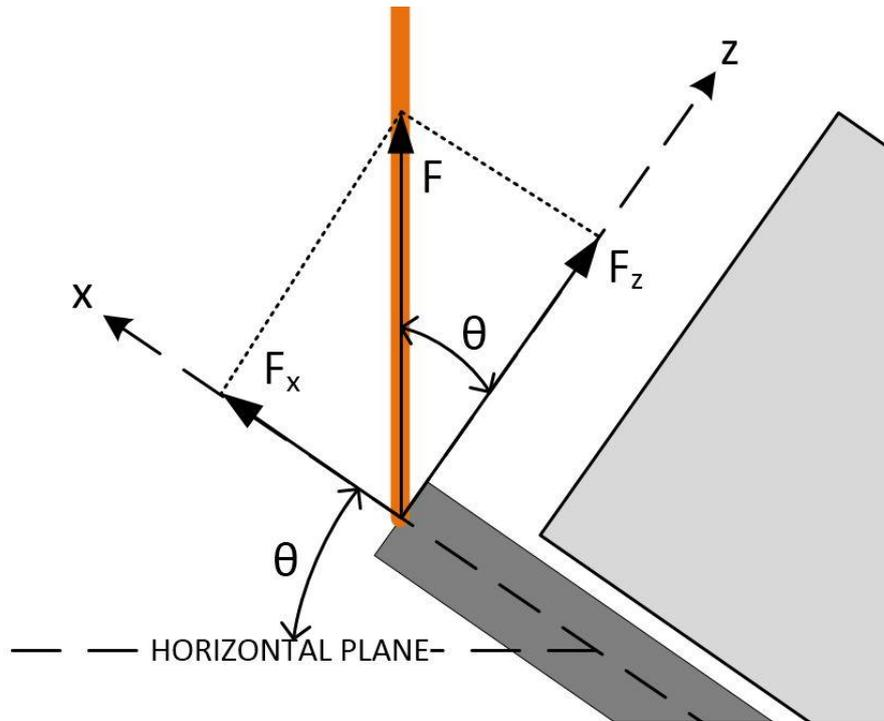
FIGURE 46: DECOMPOSITION OF SUPPORT FORCE IN FRONT
