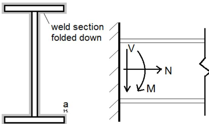
FIGURE 71: FORCES IN LONGITUDINAL - REAR BEAM JOINT
