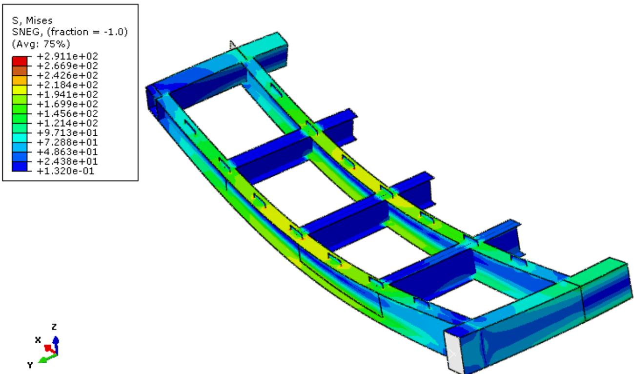
FIGURE 86: STRESS DISTRIBUTION AND DEFOMATION IN HORIZONTAL POSITION
