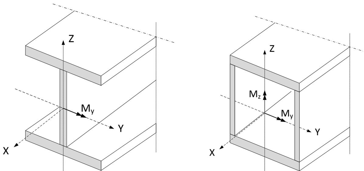
FIGURE 85: LOCAL AXIS SYSTEM OF BEAMS
