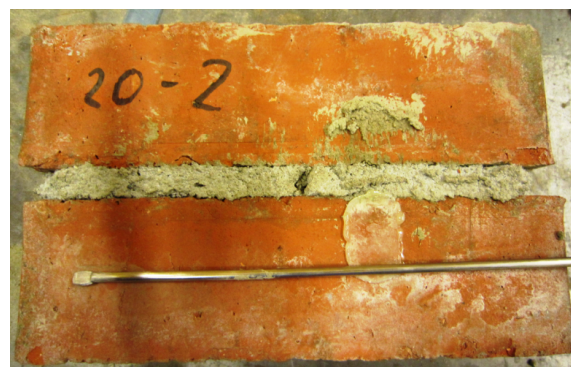
Figur 7.26: Bruddtilfelle 4: Rent forankringsbrudd (Prøvestykke 20-2)
