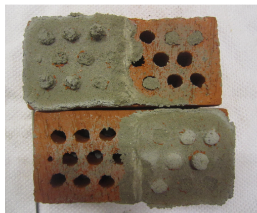
(d) Tverrsplitting av mørtelfuge etter oppbrytning av prøven
