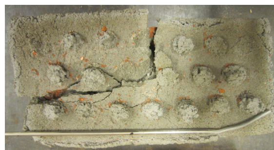
(d) Bruddtilfelle forankringslengde 65 mm
