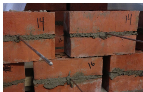
Figur 6.3: Prøvestykker etter oppmuring
