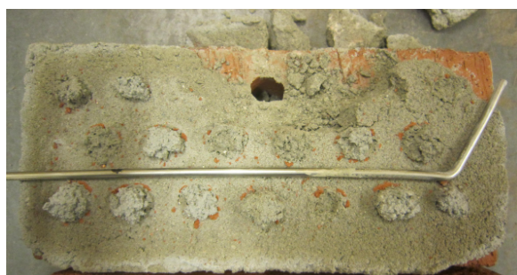
(c) Bruddtilfelle forankringslengde 40 mm
