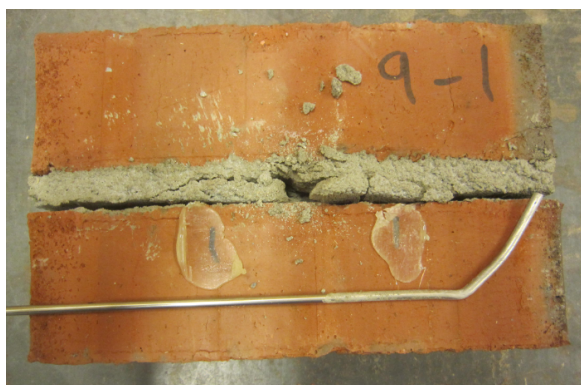
(a) Prøvestykke 9-1, forankringslengde 40 mm
