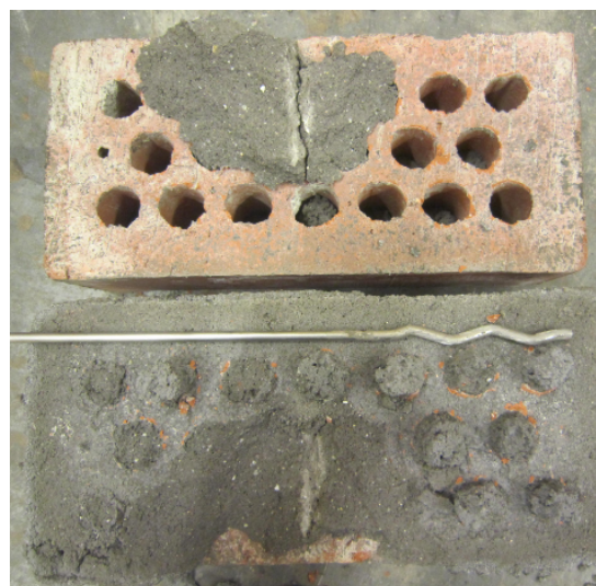
(b) Kjegleformet forankringsbrudd
