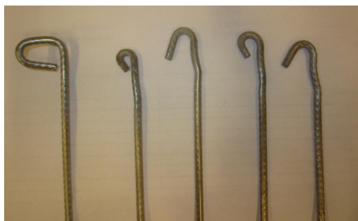
Figur 7.22: Deformasjon av binderne benyttet til testing
