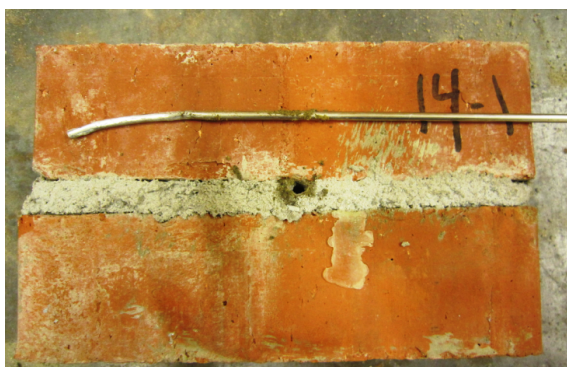
Figur 7.25: Bruddtilfelle 4: Rent forankringsbrudd (Prøvestykke 14-1)
