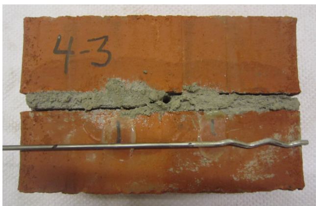
(c) Tverrsplitting av mørtelfuge
