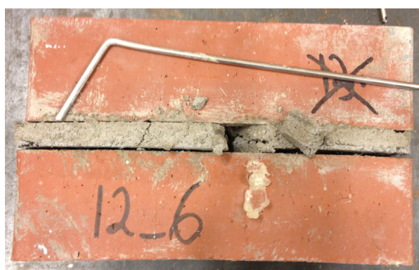
(b) Vertikallast tilsvarende fire skift (200 N)
