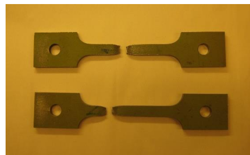
Figur 6.2: Materialprøver etter brudd
