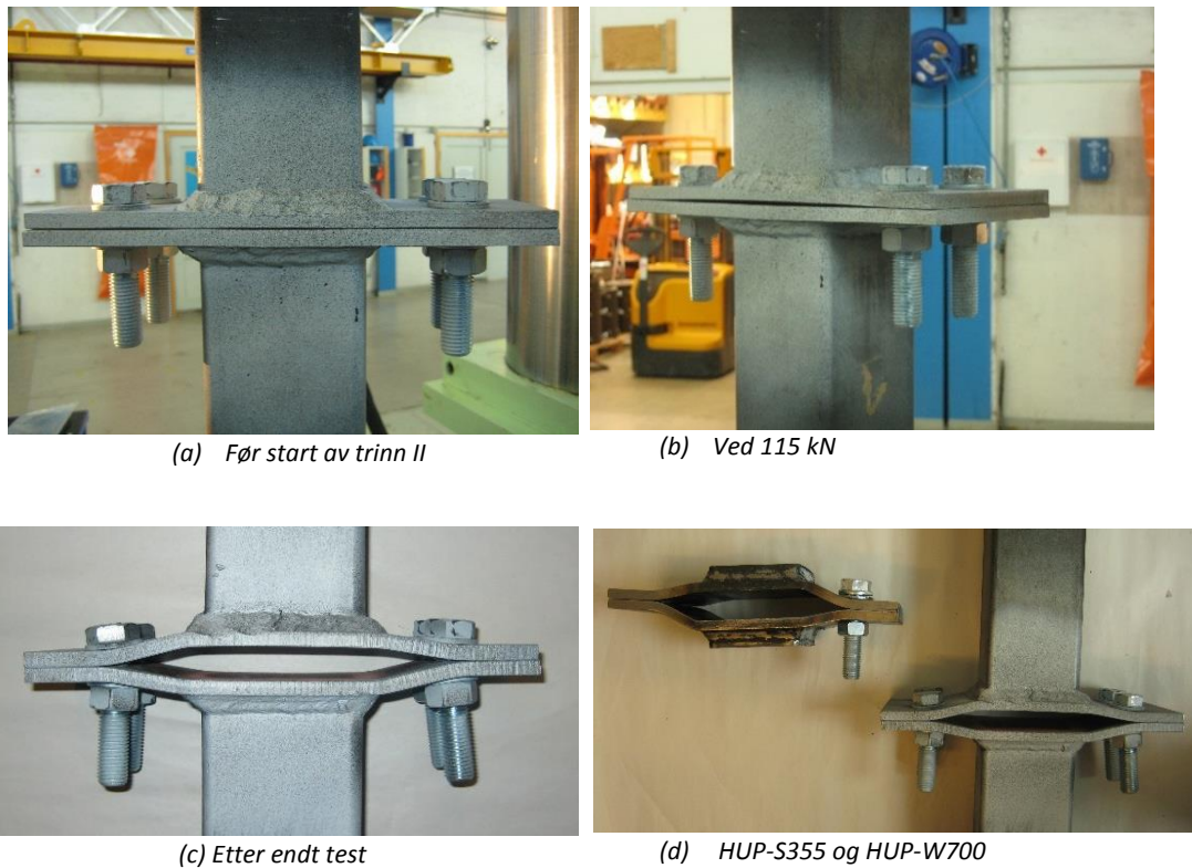
Figur 6.13: Prøve HUP-W700 etter endt forsøk
