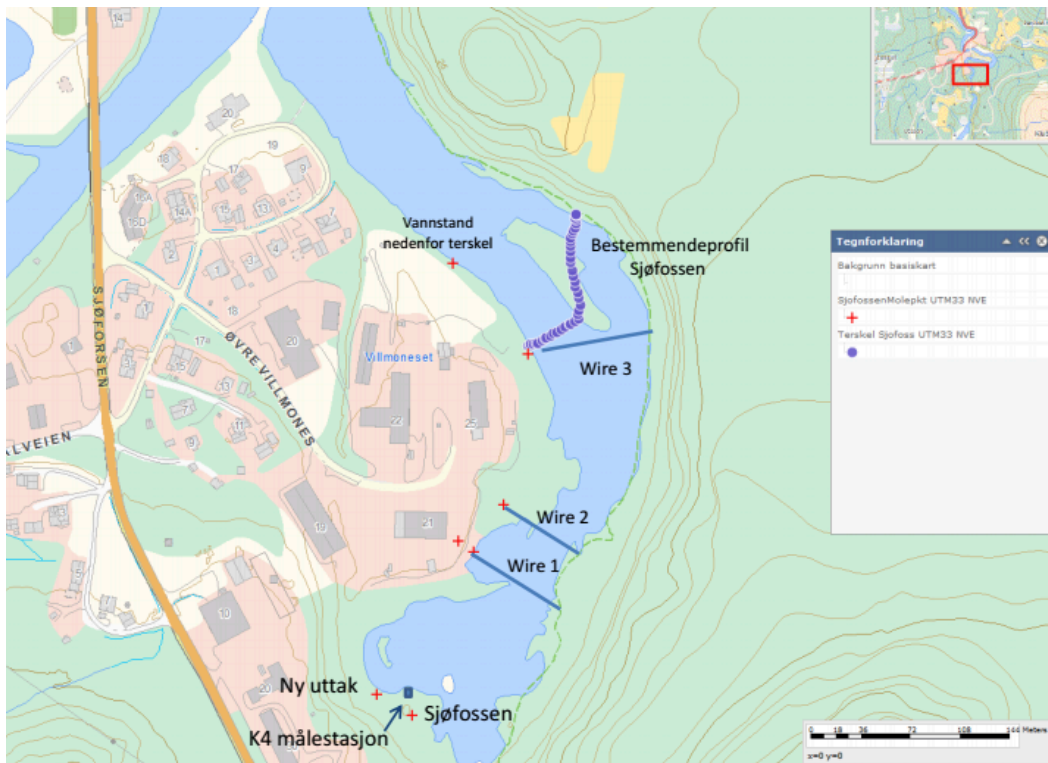
Figur 10: Punkt for hastighetsmålinger gjort høsten 2014 av Hydrateam med tillatelse fra Statkraft.
