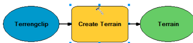
FIGUR 4.3: Modell som beskriver en forenklet arbeidsflyt fra LAS-filer og FKB-data til Terrain .
