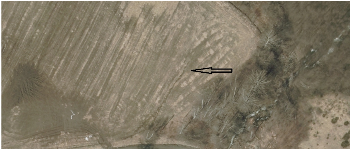
FIGUR 5.10: Ortofoto som bekrefter akkumulering av vann på jorde i område 2. Svart pil viser tegn på erosjon som kan være relatert til vann på avveie. Bilde er tatt 07.06.2013 (GEOVEKST)
