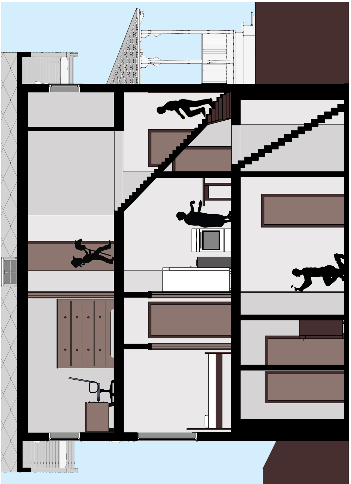
Eksisterende snitt av langside B-B' M: 1: 50.
