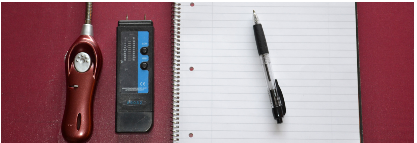
Fuktmåler som måler fuktighet i prosent, samt notatblokk, og lighter for å skille luftlekkasjer fra kuldebroer.
