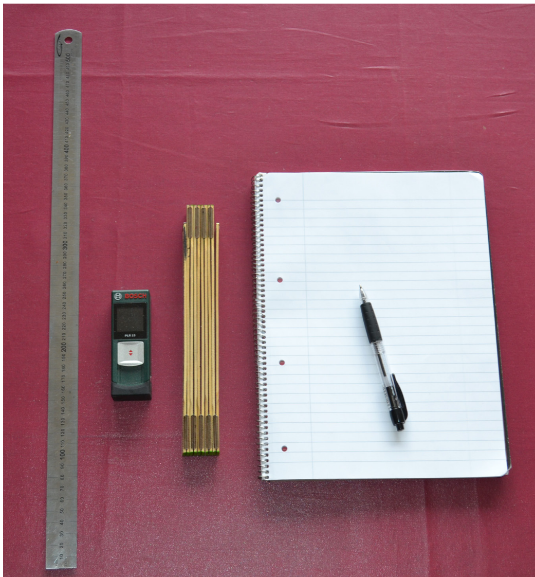
Oppmålingsutstyr: Stållinjal, lasermåler, målestokk og nedskrivningsutstyr.
