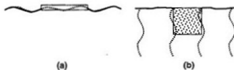
Figur 2.10: Kinematisk interaksjon med fritt felt-respons som stiplede linjer: (a) overflatefundament; (b) blokk-fundament. [15]
