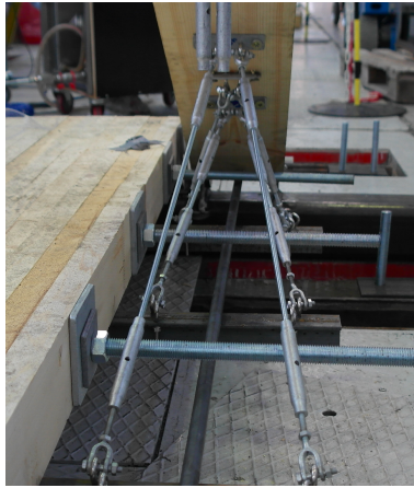
Figur 4.14.: Stag med strekkfisk i begge ender.
