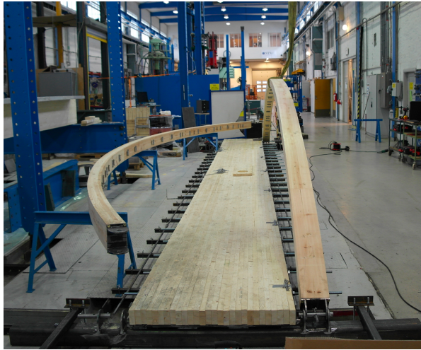
Figur 4.16.: Montering av buer.
