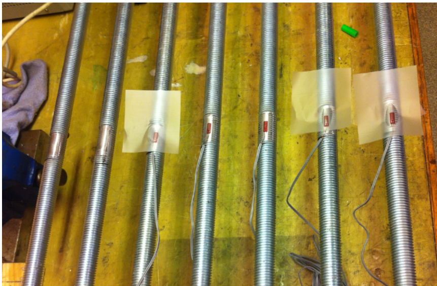
Figur 4.3.: Feste av strekkklapper.
