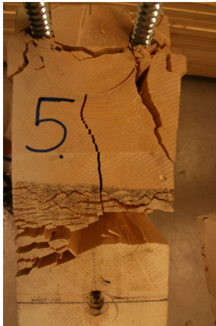
FIGUR 35 VISER OPPSPREKNING UNDER SKRUENE SOM FØLGE AV TRYKK
