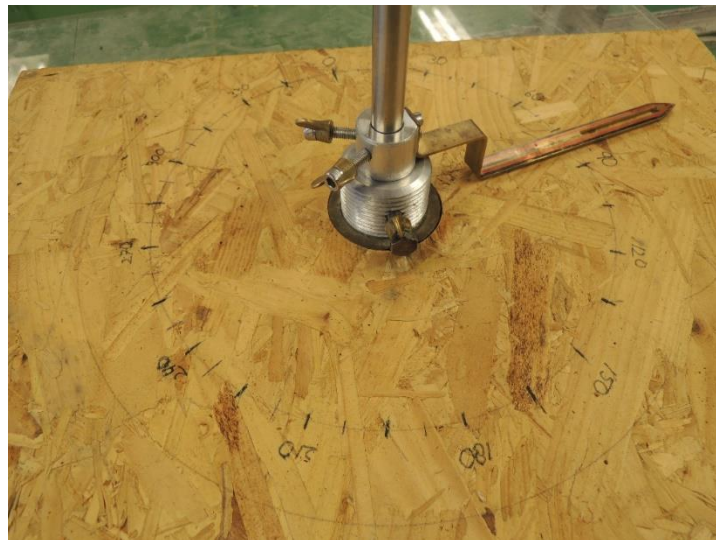
Figur 31: Bilde av gradskiven brukt for å plassere svingerne og hydrofonen
