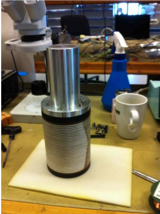
(e) Transducer belagt med første lag epoxy
