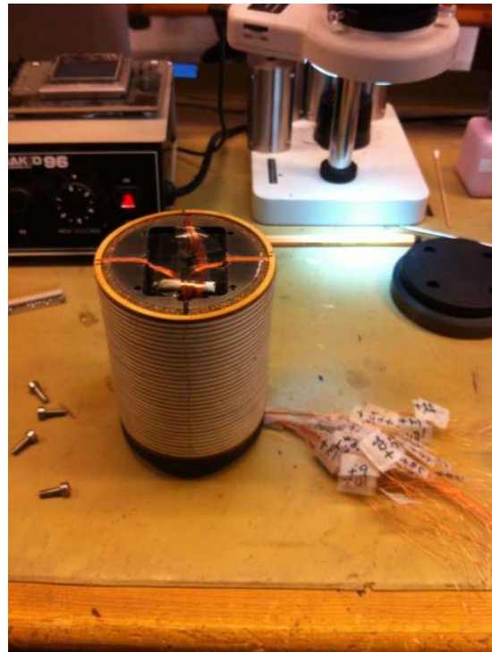
(d) Ferdig med lodding og montering
