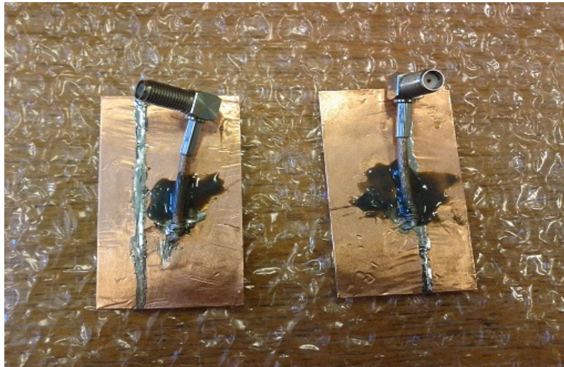
Figur 39: Modifiserte testantenner sett fra undersiden
