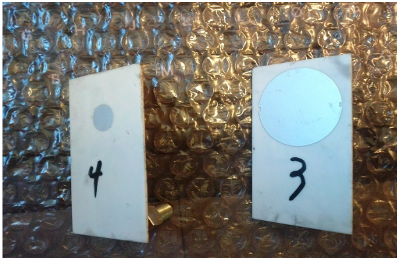
Figur 40: Modifiserte testantenner sett fra oversiden (venstre side testantenne 1 og høyre side testantenne 2)
