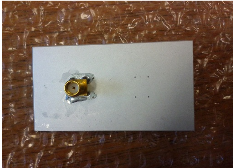
Figur 37: Matenettverk sett fra undersiden
