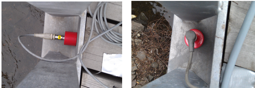
Figur 8.1: Horisontal og vertikal plassering av akselerometer
