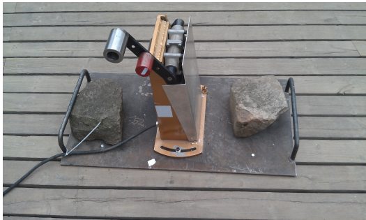
Figur 8.5: Ristemaskin benyttet til å kartlegge den horisontale egenfrekvensen
