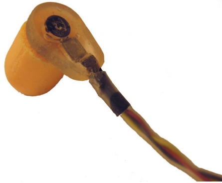
Figur 3.11: Bilde av prototypen for propp 1 der mikrofonen er støpt inn.
