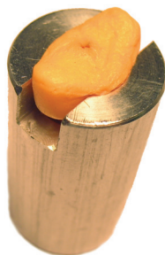
Figur 3.6: Skumproppen ble fylt med vann og plassert i denne metallsylinderen for at det skulle være lettere å bore et jevnt og rett hull gjennom proppen.
