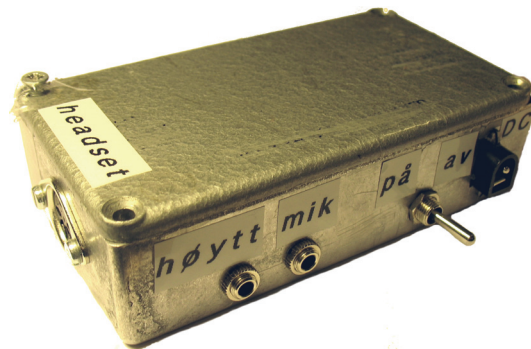
Figur 3.17: Boksen som inneholdt mikrofonforsterkeren. Den har tilkobling til headset, mikrofon- og høyttalersignal til PC, og strømminntak.
