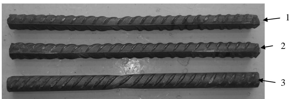
Figur H.2: Strekkprøver fra 3 armeringsstenger av B500NC etter brudd.
