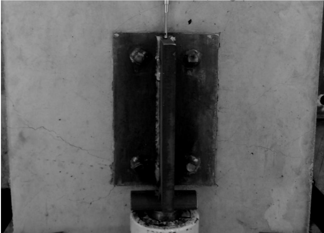
Figur 12.3: Bruddform på overflaten av betongprøvestykket A1.3.
