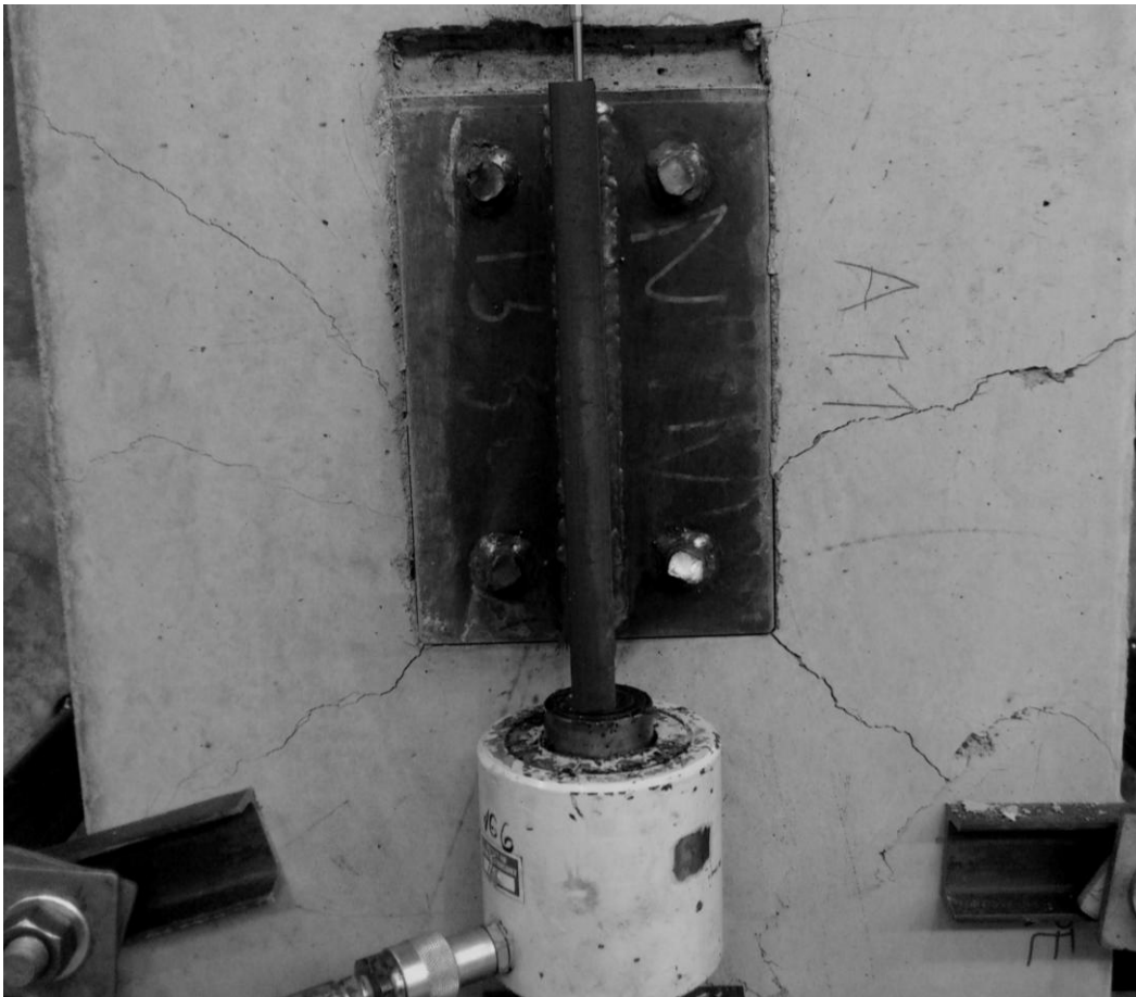
Figur 12.2: Bruddform på overflaten av betongprøvestykket A1.1.
