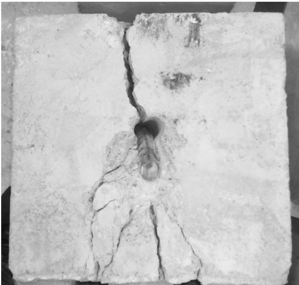
Figur 10.12: Prøvestykke med Ø20, betongkantbrudd og brudd i dybel.
