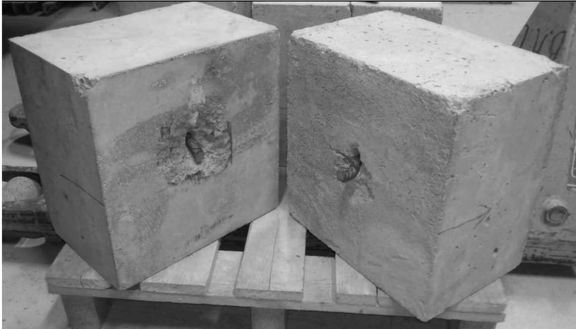
Figur 10.11: Prøvestykke med Ø16, avskalling av betongen og brudd i dybel.
