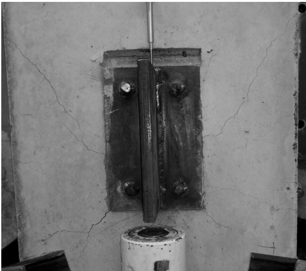
Figur 12.6: Bruddform på overflaten av betongprøvestykket B2.1.
