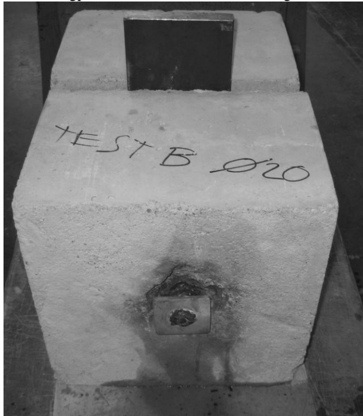
Figur 10.3: Betongprøvestykkene med stålplate i mellom.
