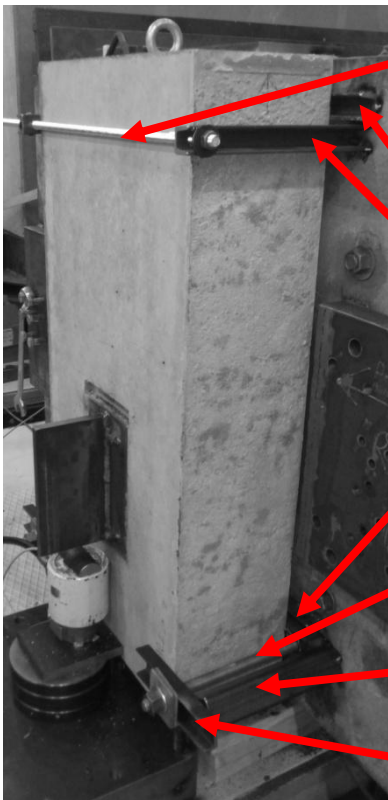
Figur 11.12: Viser opplager til forsøksoppstilling.
