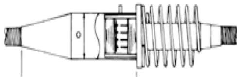
Figur 3.7: Fast kobling, skjøt til spent kabel, type Sh
