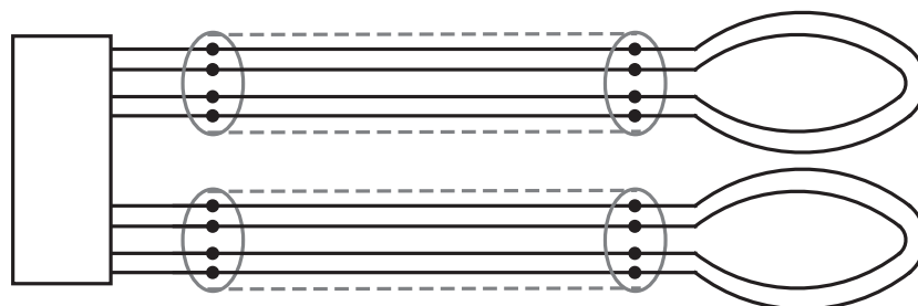
Figur 2.5: System som består av to skjermede detektorløyfer.
