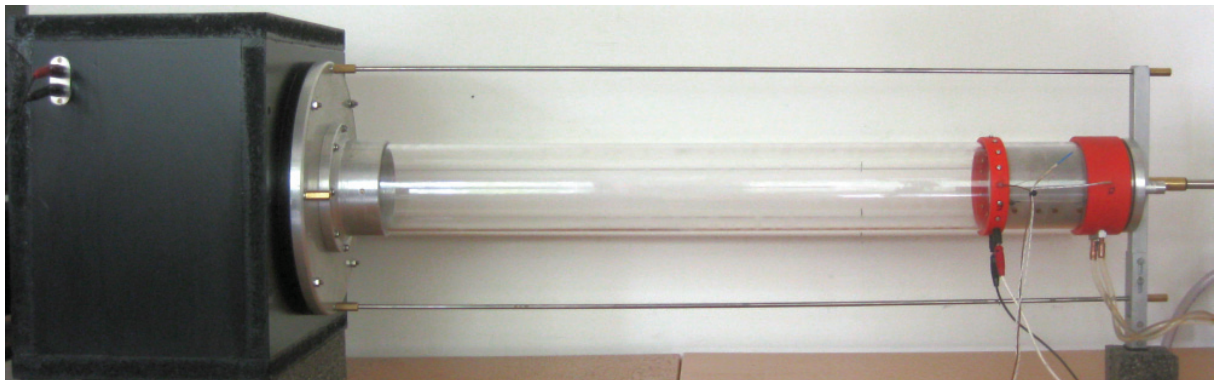
Figur 4.3.8. Ferdigbygget kjøler med montert varmetråd og varmeveksler samt tilkoblet termometer og vann.
