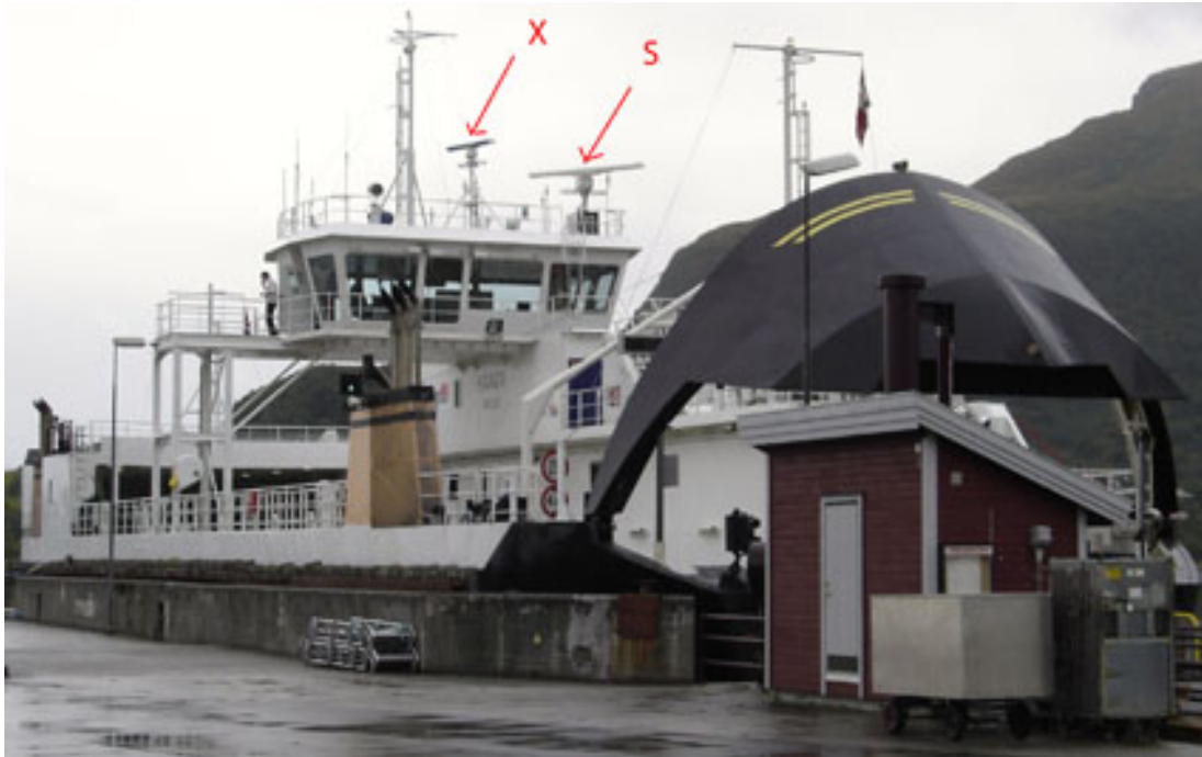
Figur 2.4.: MF «Harøy» til kai. Plasseringen av antennene for X- og S-bånd presisert.
