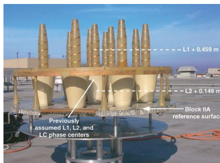
Figur 5.6: Forskjellige fasesenter for L1 og L2 for en satellittantenne
