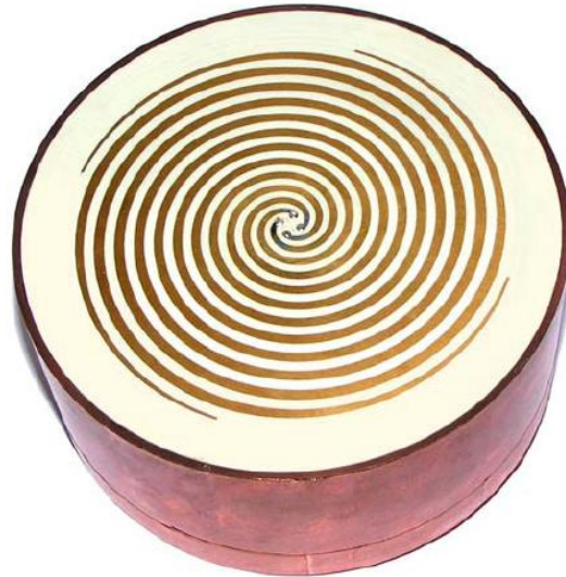
Figur 5.7: Spiralantenne for bruk med Galileo og modernisert GPS
