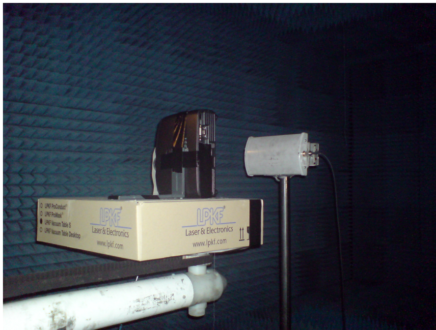
Figur 4.1: Oppsett for måling av leseavstand på prosjektør i antennehall
