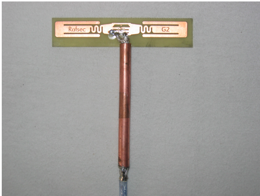
Figur 4.6: Antennestrukturen for «Rafsec UHF PE IMT» påtrykt kretskort med tilkoblet koaksialkabel og balun
