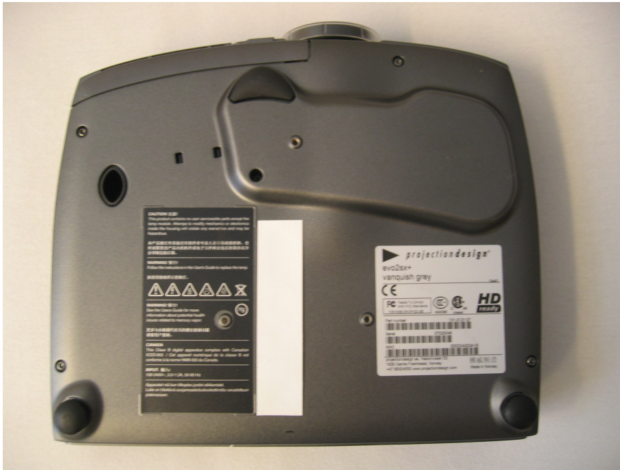
Figur 4.2: RFID-transponder påmontert prosjektør, vist som den hvite etiketten i senter av prosjektøren
