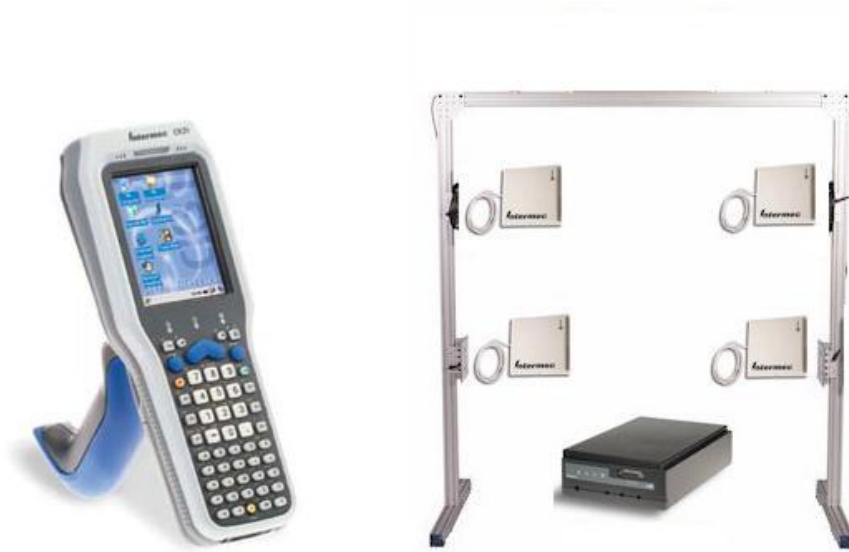
Figur 2.10: Figuren viser til venstre en håndholdt RFID-leser, og til høyre et stasjonært RFID-system [17] [18]
