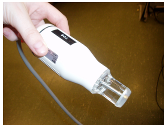
Figur 3.4: RMV-probe. Proben på bildet har senterfrekvens på 55 MHz.
