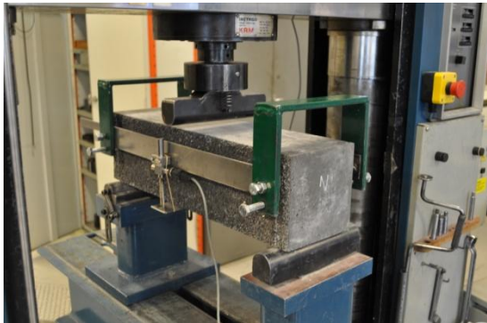
Figur 58: Test for å finne bøyestrekfasthet
