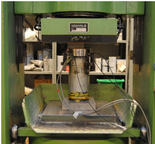
Figur 56: Test for å finne trykkfasthet
