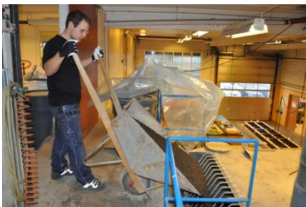
Figur 31: Tilslag blir tømt i betongblanderen
