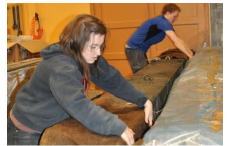
Figur 43: Fuktige striesekker blir plassert på bjelken
