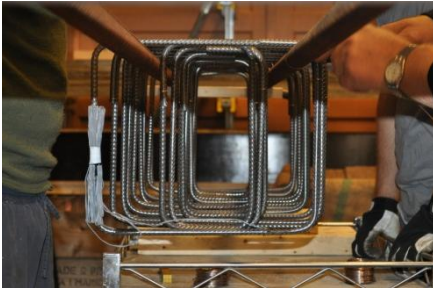
Figur 21: Binding av armering
