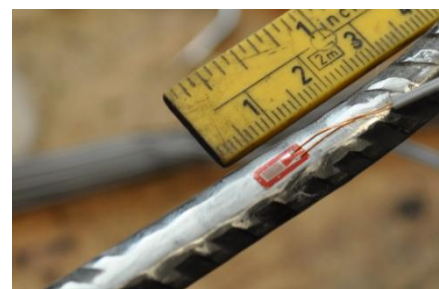
Figur 18: Strekklappen er plassert
