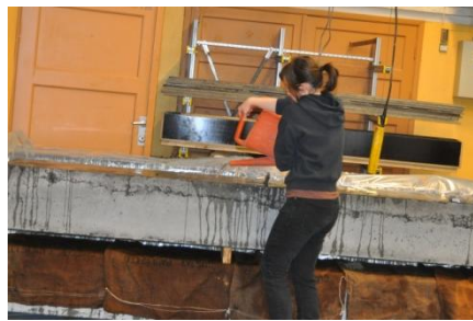
Figur 42: Betongbjelken blir vannet
