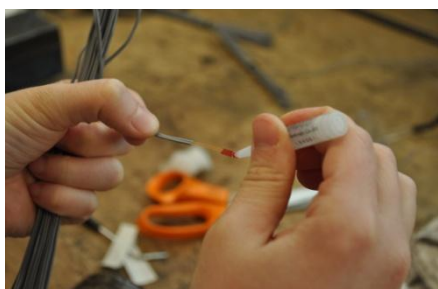
Figur 16: Lim på strekklapp
