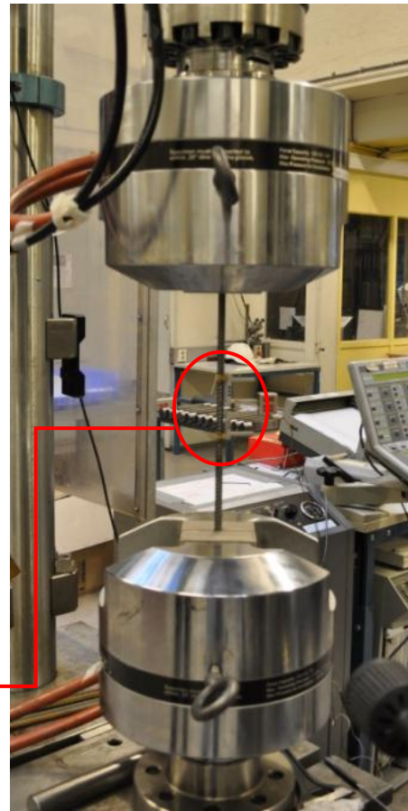
Figur 61: Test av armeringsjern
