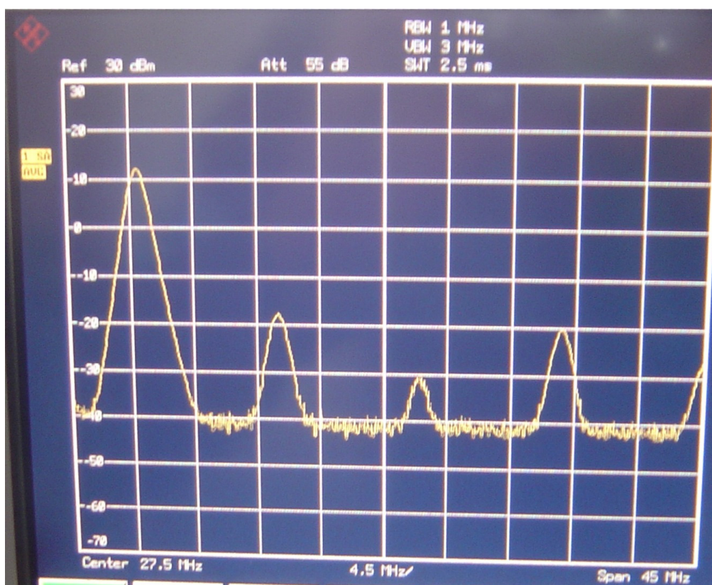
Figur C32 Effektspektrum ved 20dBm inngangseffekt, med \pi -nettverk.
