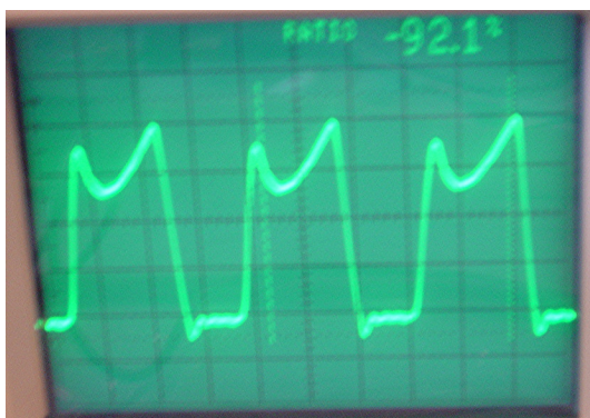
Figur C7 Målt drain-source spenning ved 0dBm inngangseffekt, uten \pi -nettverk
