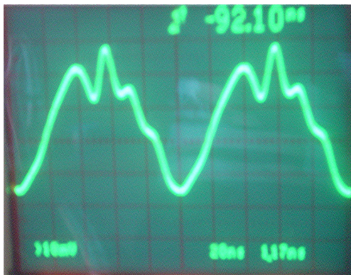
Figur C23 Målt drain-source spenning ved 0dBm inngangseffekt, hovedforsterker
