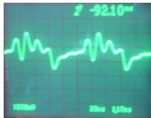
Figur C24 Målt drain-source spenning ved 20dBm inngangseffekt, hovedforsterker
