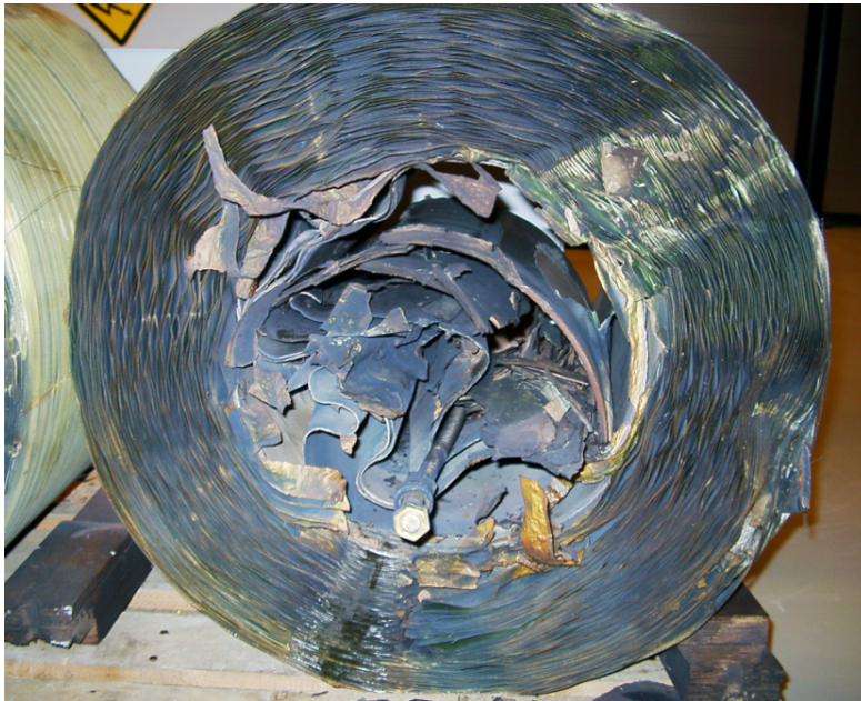
Figur E.1: Foto av strømbegrensende spole etter kortslutning.
