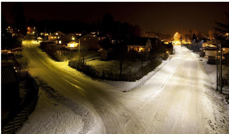
Figur 2.3: Bildet viser en vei med høytrykknatriumlamper til venstre og LED til høyre. Bildet er tatt av Asker kommune [16].
