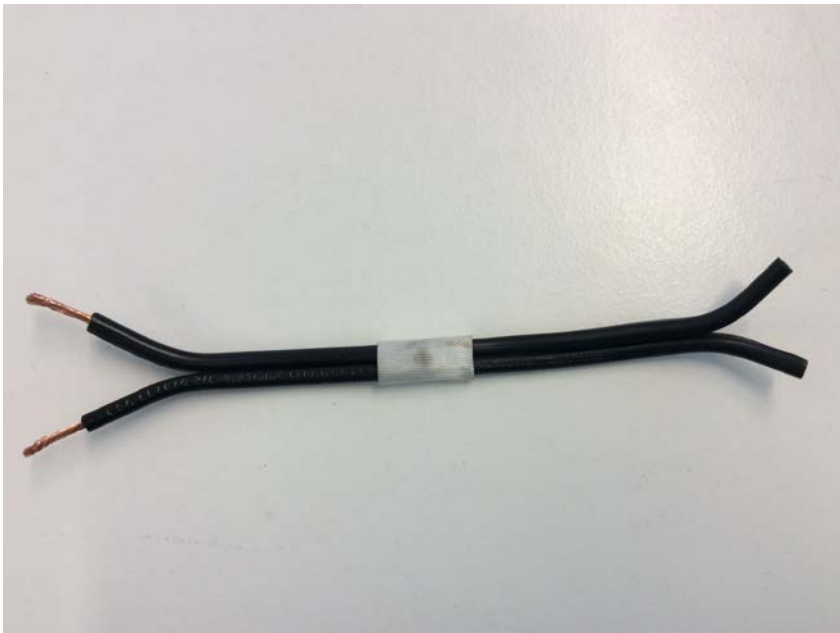
Figur 50 - Kabelprøve der det ved bruk av høy spenning over kort tid er laget en karbonisert vei mellom lederne. De avisolerte endene ble tilkoblet kretsen, slik at lysbuen som oppstod mellom lederne ble en serielysbue.
