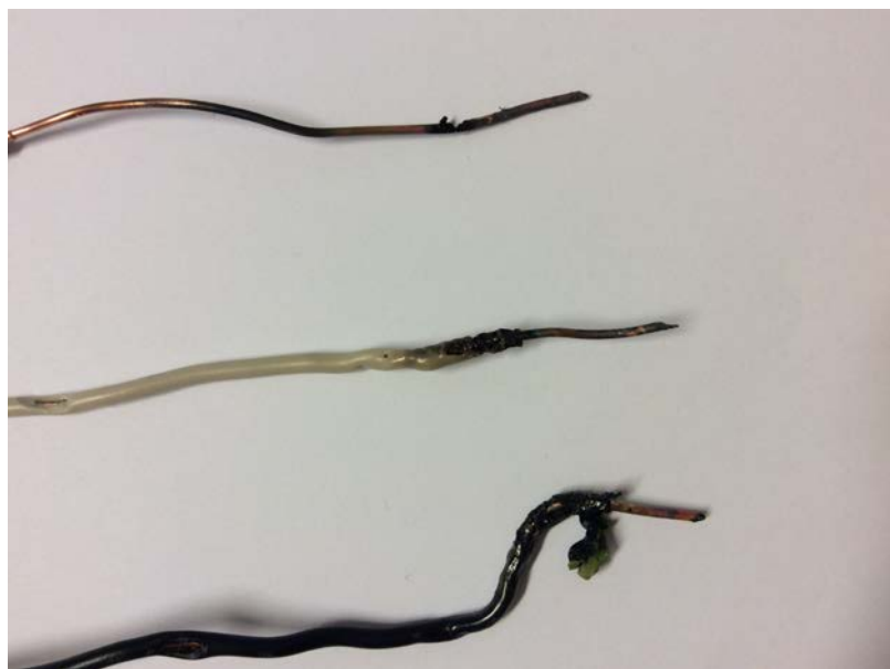
Figur 53 - Ledere utsatt for varmgang og lysbuer.
