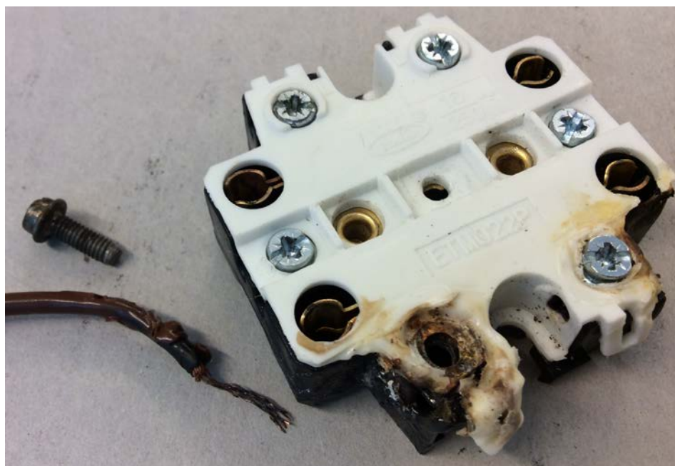
Figur 47 – Stikkontakten med seriefeilvernet som skaper jordfeil ved temperaturstigning over smeltelegemets grenseverdi.
