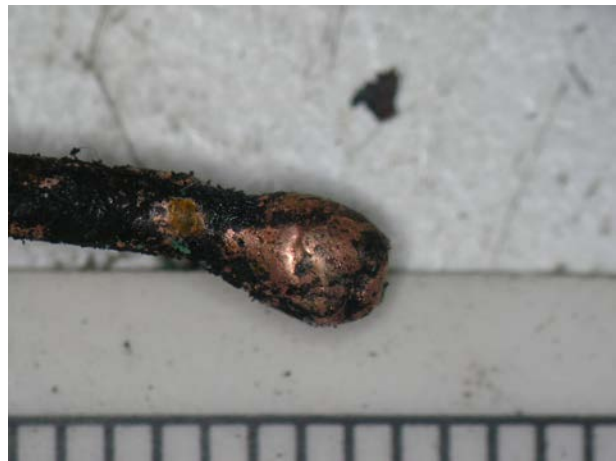
Figur 21 - Dette viser lysbueskader på en av lederne i flerlederen som ble innsatt i en innstikk-klemme. Bildet ble utvekslet i en mail med Overingeniør Wiggo Knudsen ved KRIPOS, seksjon for brann og kjemi 10. Mars 2015, og er gjengitt med tillatelse.
