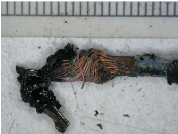
Figur 20 - Feil type leder ble innsatt i en innstikk-klemme; dette førte til motstandsoppvarming med påfølgende lysbue. Bildet ble utvekslet i en mail med Overingeniør Wiggo Knudsen ved KRIPOS, seksjon for brann og kjemi 10. Mars 2015, og er gjengitt med tillatelse.
