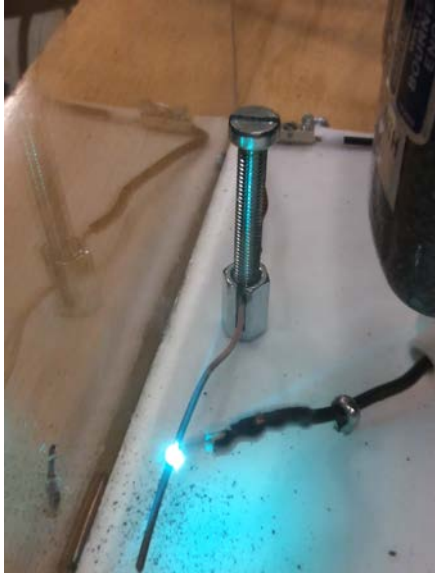
Figur 54 - Lysbue mellom to ledere utsatt for vibrasjoner
