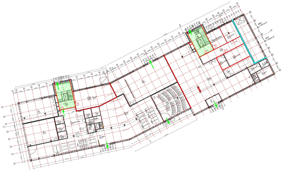
Figur 6-3: Branntegning for 1-etasje.
