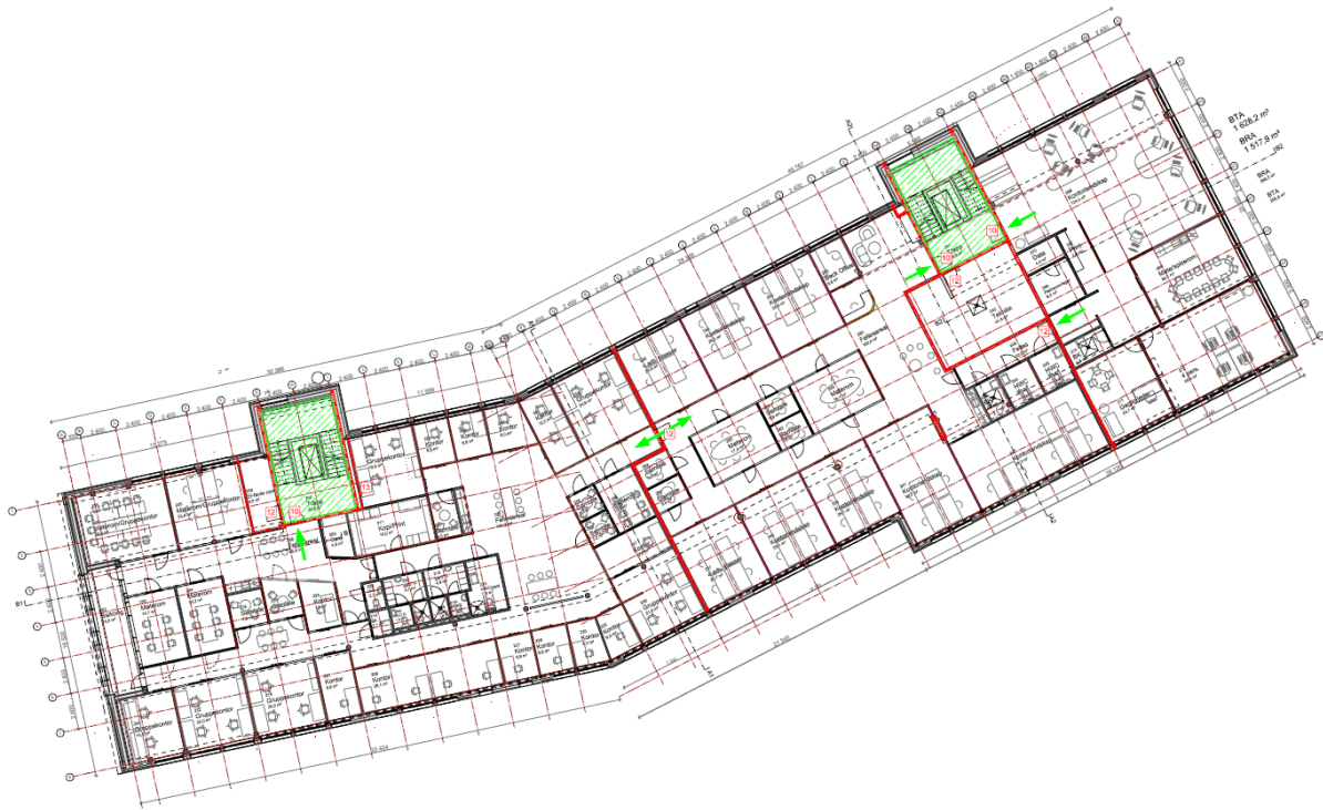
Figur 6-4: Branntegning for 2-etasje.
