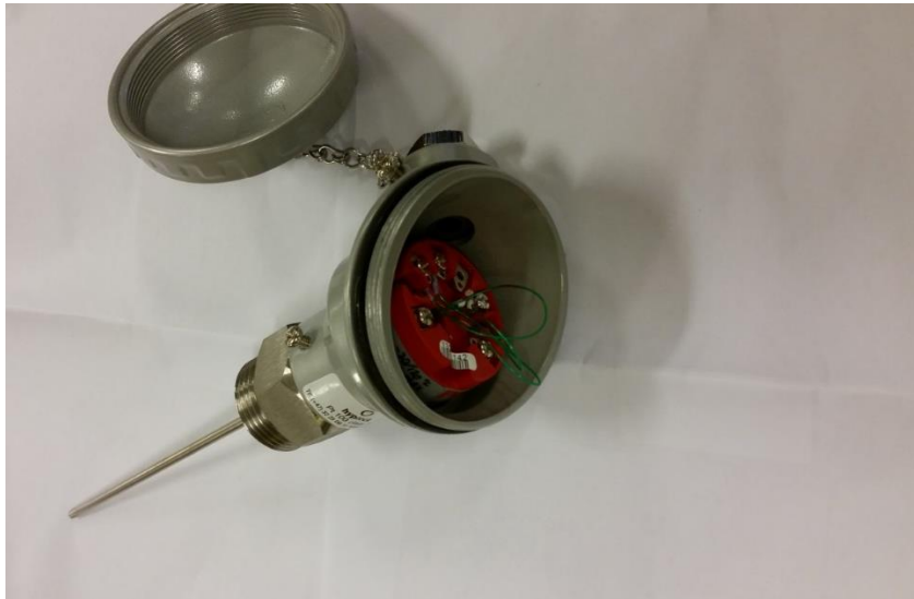
Figur 10: Bilete av temperaturmålar for kontinuerleg måling
