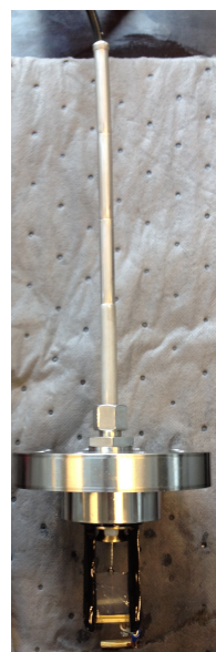
Figur 3.11: Kabelgjennomføring i trykktett lokk.
