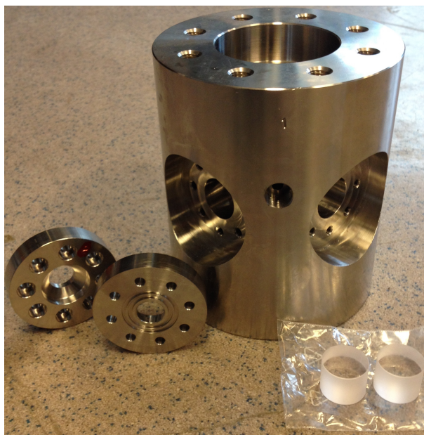
Figur 3.9: Trykktank med glassvindu og flenser for å holde vinduene på plass. Legg merke til dobbelt O-ringspor på flensen.
