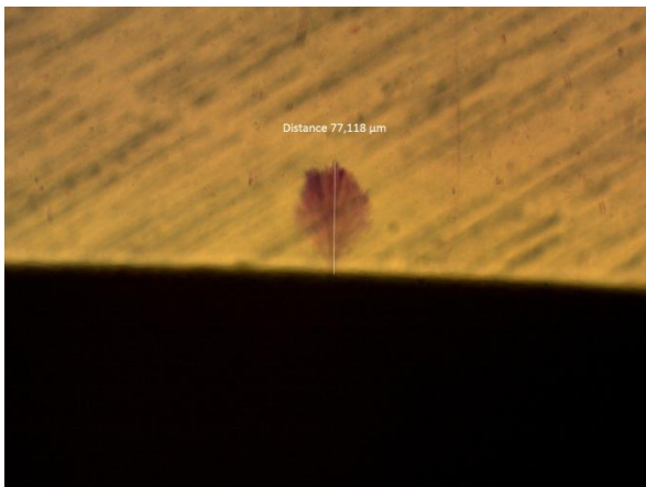
Figur A.12: Et av de få ventilerte vanntrærne funnet i denne oppgaven. Treet ble funnet ved den indre halvlederen i prøveobjektet med leder, uten strekk ved 40 °C.
