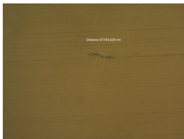
Figur A.3: Det største vantreet i prøveobjektet uten leder, uten strekk ved 18 °C
