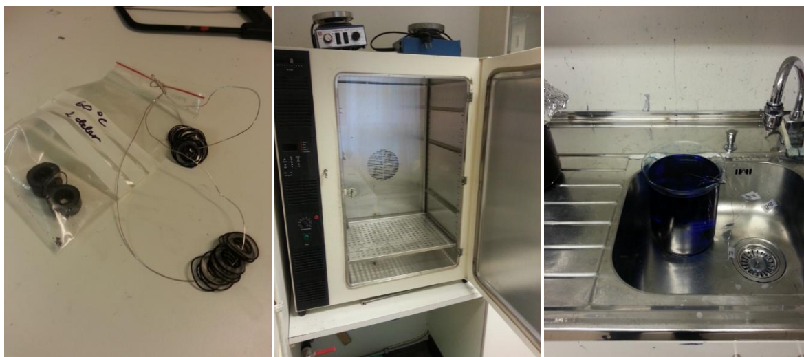
Figur 3.18: (V) Snitt festet til en ståltråd, (M) varmeskapet med to magnetrørere og (H) vannbad med snitt oppi [8]
