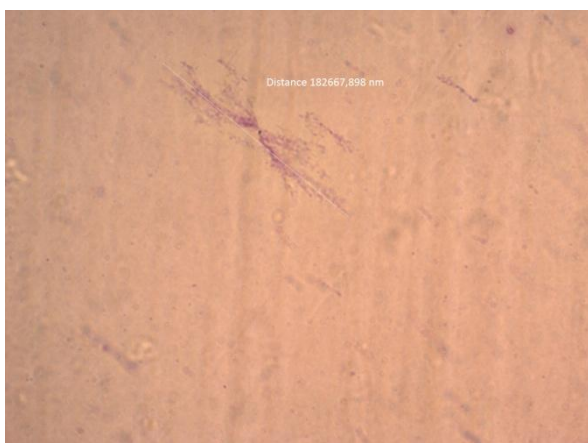
Figur A.9: Det største vanttreet i prøveobjektet uten leder, uten strekk ved første gjennomkjøring av 60 °C
