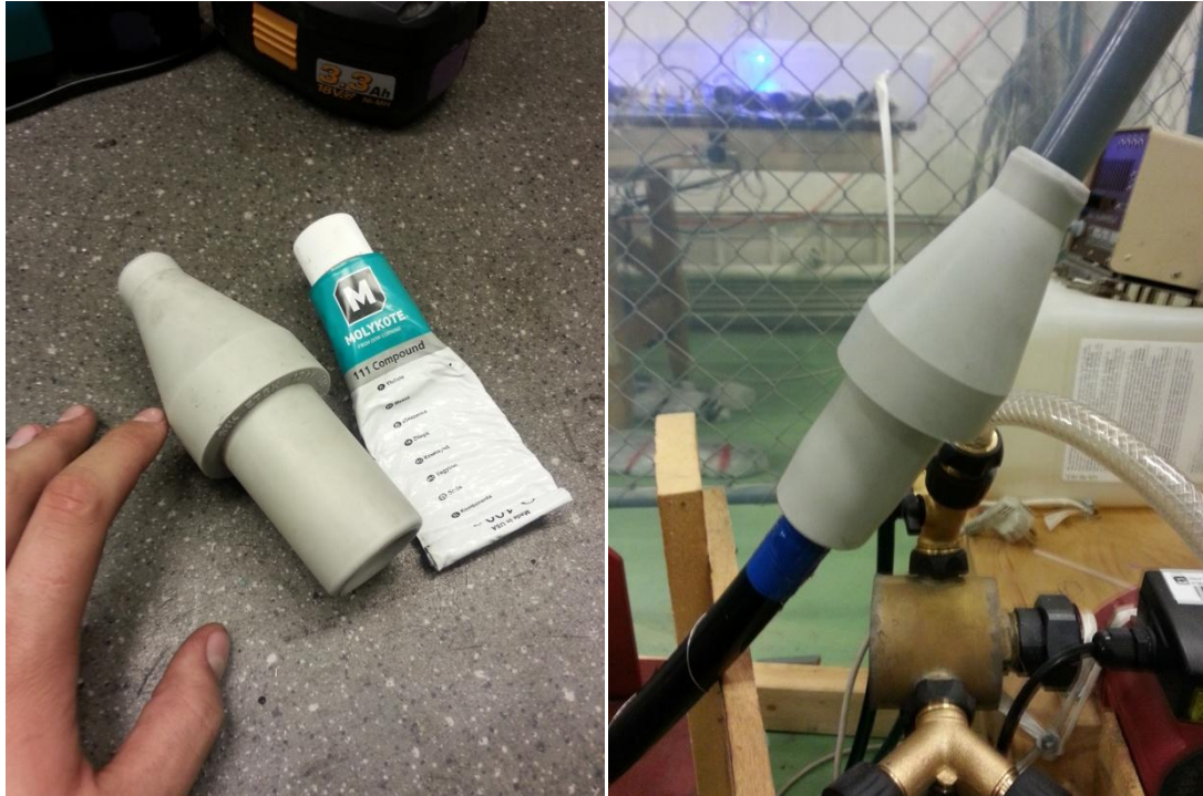
Figur 3.10: (V) Stresskone og silikonpaste, (H) Stresskone plassert på en av kabelendene [8]
