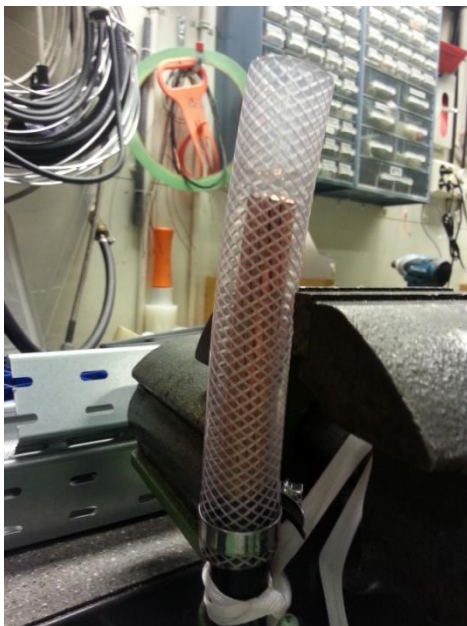
Figur 3.4: (V) Plastrøret plassert på kablen, (H) Kablene hengt opp til gjennomstrømning [8]
