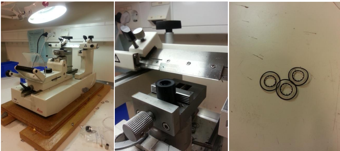
Figur 3.17: (V) Mikrotomet, (M) en av kabeldelene festet i mikrotomet og (H) tre ferdige snitt [8]
