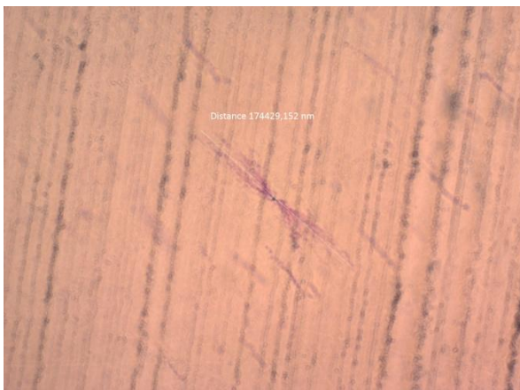
Figur A.7: Det største vanntreet i prøveobjektet med leder, uten strekk ved første gjennomkjøring av 60 °C
