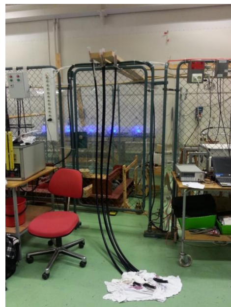
Figur 3.4: (V) Plastrøret plassert på kablen, (H) Kablene hengt opp til gjennomstrømning [8]
