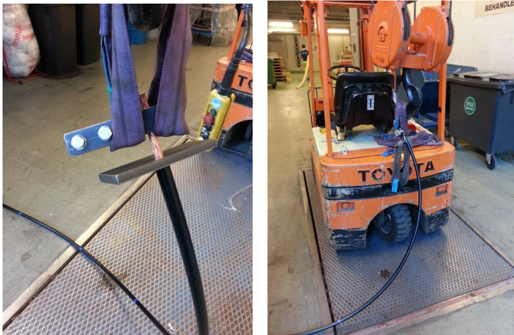
Figur 3.5: Isolasjonen holdes tilbake av trucken mens lederen dras ut av kranen
