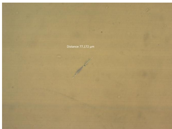
Figur A.1: Det største vantreet i prøveobjektet med leder, uten strekk ved 18 °C
