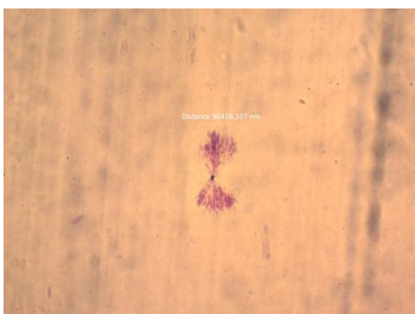
Figur A.10: Det største vanttreet i prøveobjektet med leder, uten strekk ved andre gjennomkjøring av 60 °C
