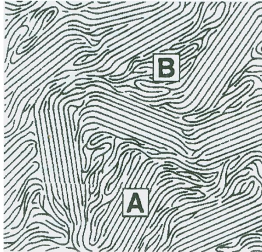
Figur 2.6: Strukturen til en polymer med krystalliserte (A) og amorfe regioner (B) [1]
