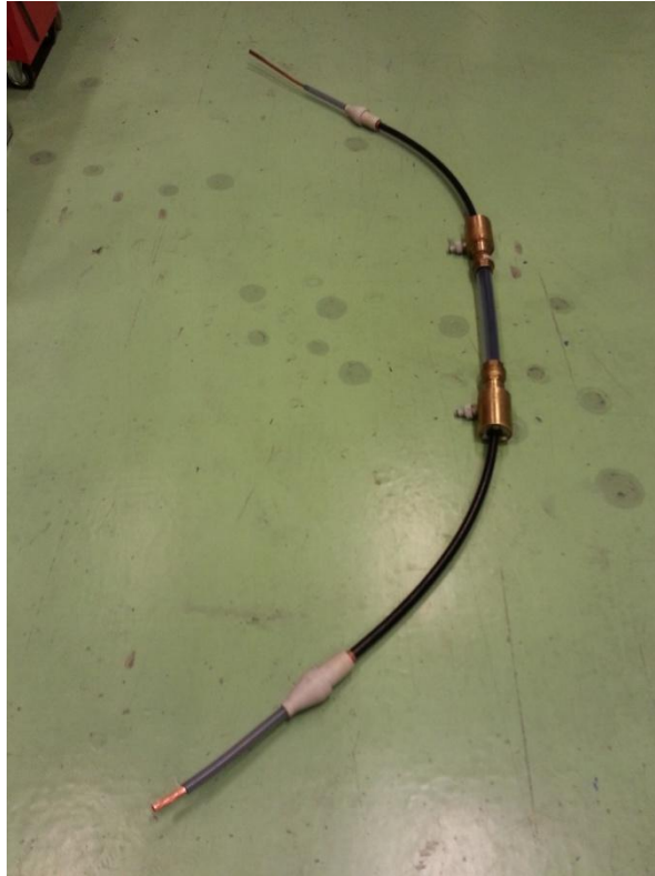
Figur 3.13: Et ferdiglaget prøveobjekt med leder klar for installasjon
