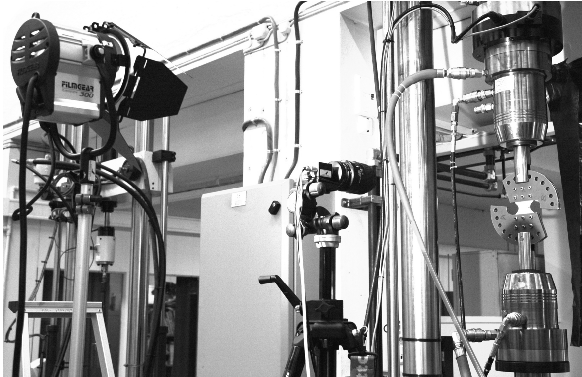
Figur 5.10: Testoppsett for Arcan testene.
