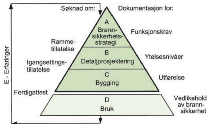
Figur 3.11: Ansvarsfordeling ved brannsikker prosjektering av ventilasjonsanlegg [16]
