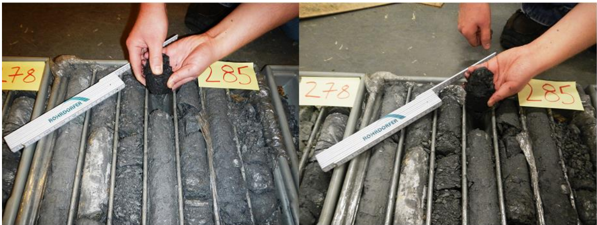
Figur 28: Løsmassemateriale fra Krågøy BH-03-11C som er fuktet
