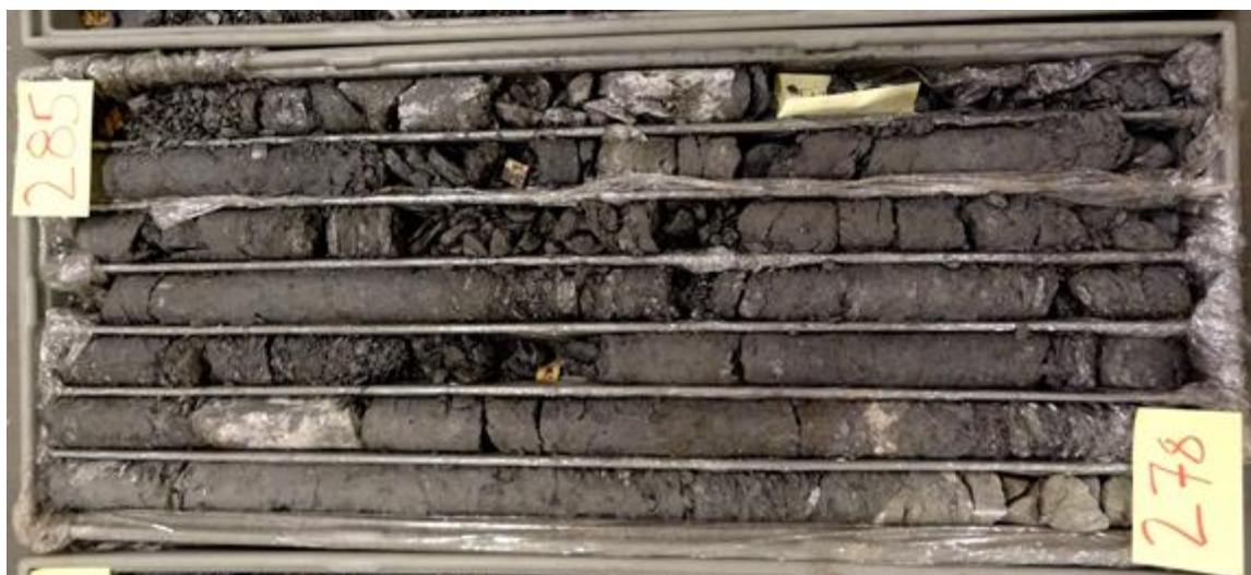
Figur 10: Bilde av svakhetssone med breksje og oppsprukket svartskifer med innhold av sleppemateriale/leire i borehull Krågøy BH-03-11C (foto: Øyvind Dammyr)
