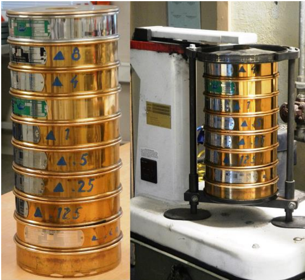
Figur 25: Utstyr til tørrsikting
