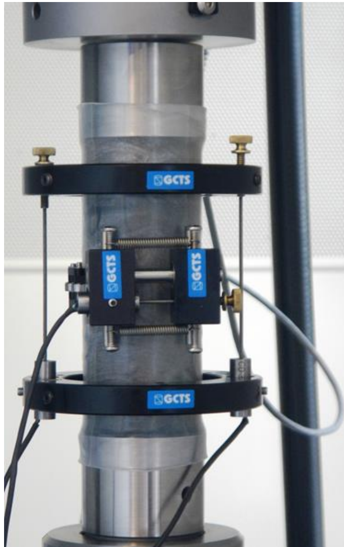
Figur 22: Kjerneprøve klar for UCS testing
