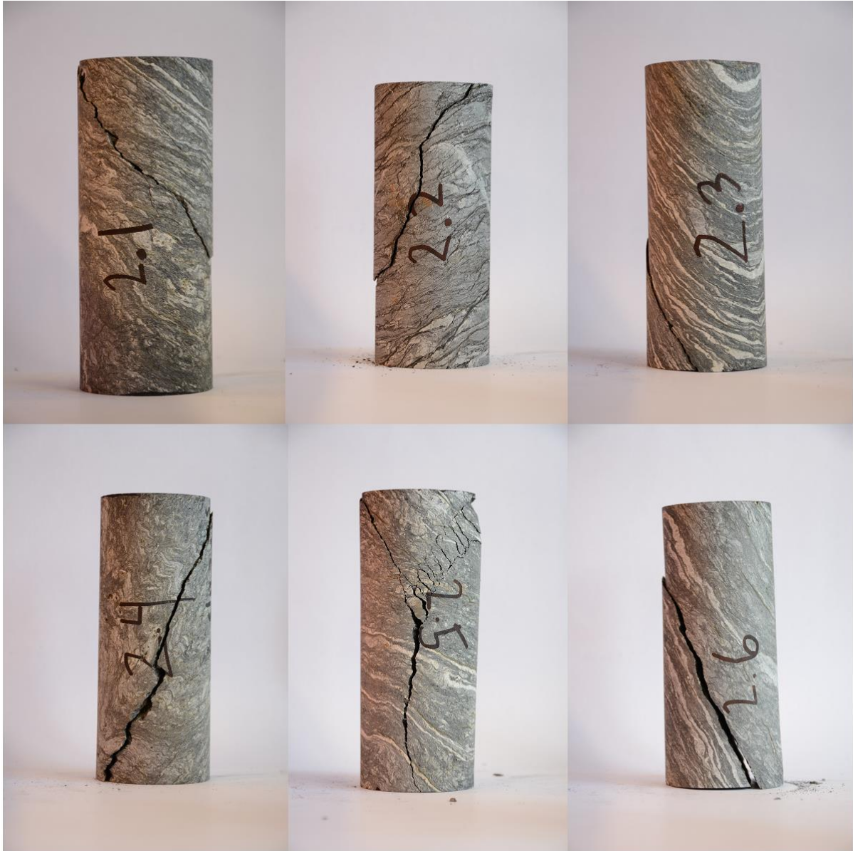
Figur B-3 Krågøy BH-03-11C prøvestykker etter UCS test
