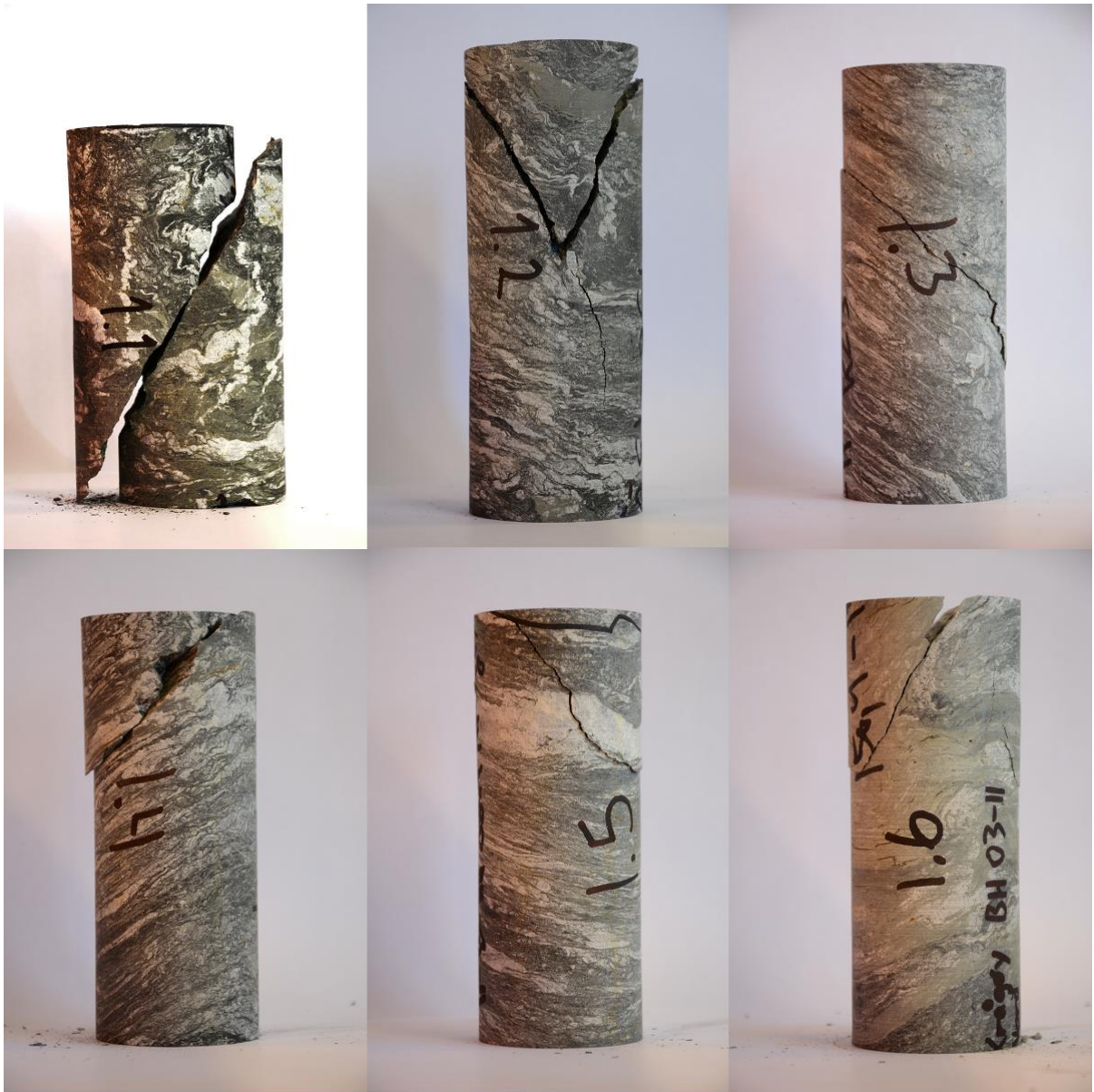
Figur B-2: Krågøy Nord BH-03-11 prøvestykker etter UCS test
