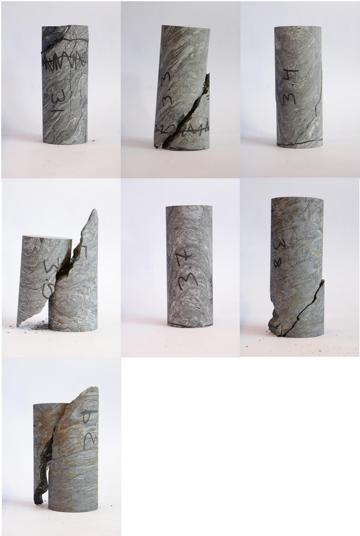
Figur B-4: Hestholmen BH-02-11B prøvestykker etter UCS
