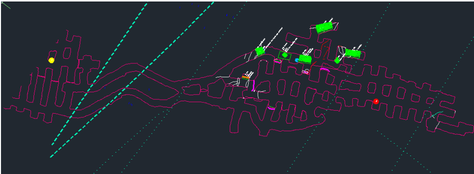
Figur 4.2: En oversikt over nivå 138 i gruen med detaljer om hvor det har blitt boltet (grønne felt), blokkfall (rødt punkt) og forkastninger (stiplede linjer). Hentet fra Microstation kart motatt av Norcem.
