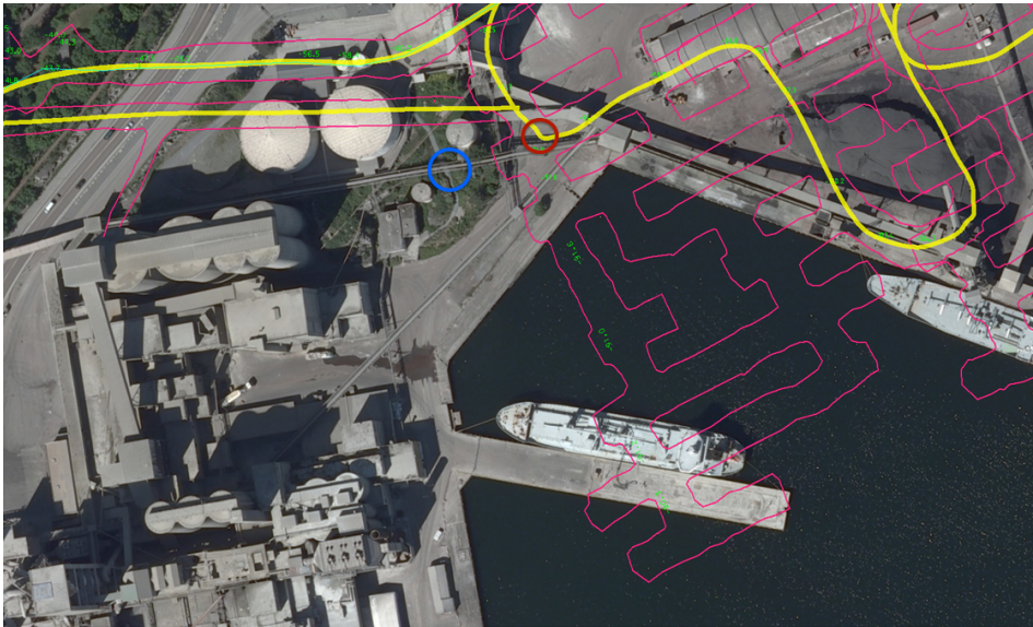
Figur 4.17: Vinklet borehull fra gruvegang til fabrikk. Den røde sirkelen viser hvor hullet starter i gruvegangen, mens blå sirkel viser hvor hullet kommer opp i dagen. Gul linjen viser kjørevei nede i gruvesystemet.
