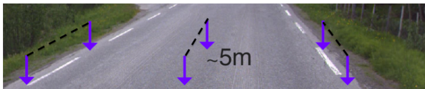
Figur 5.4: Illustrasjon av GPS-målinger langs veg. Målinger er tatt for omtrent hver 5. m.
