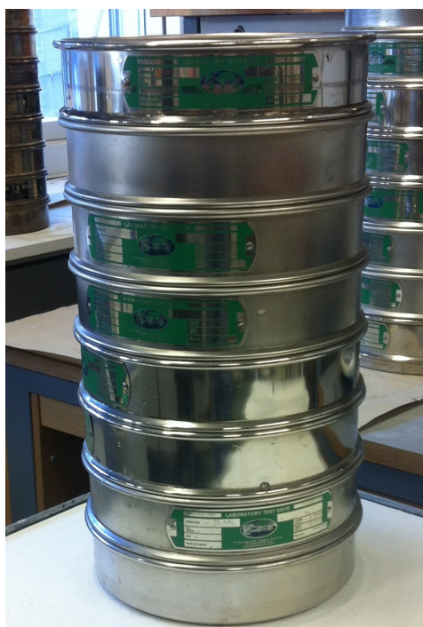
Oppsett for våtsikting av undergrunnsmateriale. Ps ikke alle siktesatser er med på bildet.
