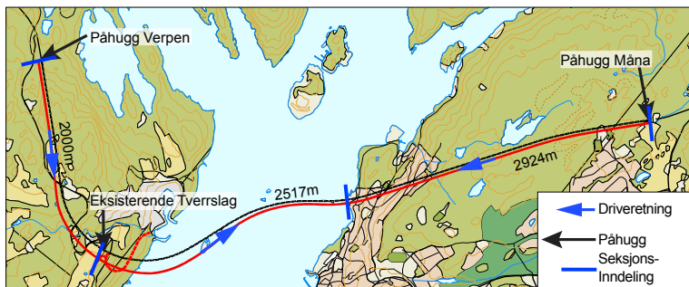
Figur 7.2: Oversikt over påhugg og tverrslag ved konvensjonell drift.
